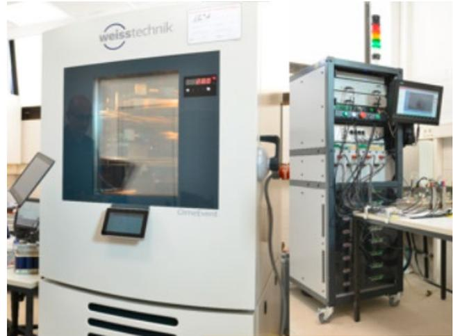
Bild 10: Klimakammer und Powercycler im Zuverlässigkeitslabor
