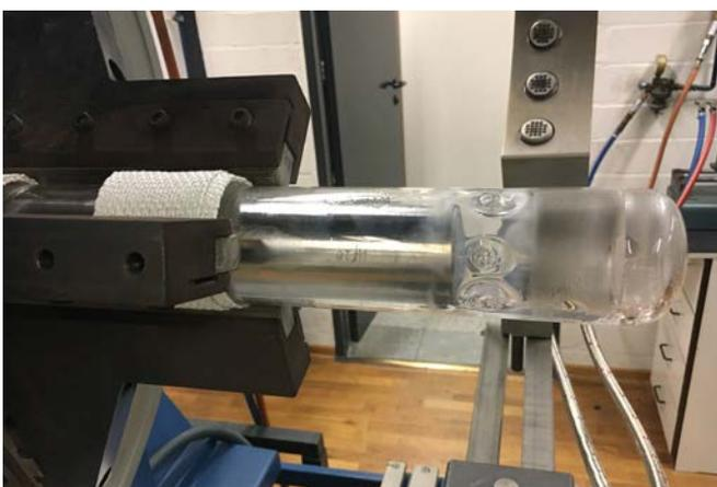
Die Brenner sind noch nicht ganz aus und schon bildet sich Kondenswasser in der Kapsel. Deshalb geht es ganz schnell an die Vakuumpumpe. Das ist sehr wichtig, da einige Metalle sofort Rost ansetzen.
