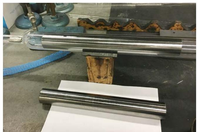
Eine echte Herausforderung. Die Gefahr besteht darin, dass die schwere Probe das Quarzrohr in der Drehbank zertrümmert. Deshalb fiel die Entscheidung auf ein 55er Rohr mit 4mm Wandung. So bleiben nur 2mm Spiel für die Probe und es poltert nicht zu sehr beim Verschließen des Rohres.
