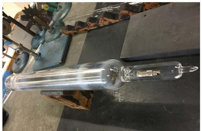
Und hier die evakuierte Probe. Der Belag stört nicht und wird deshalb nicht abgebrannt.
