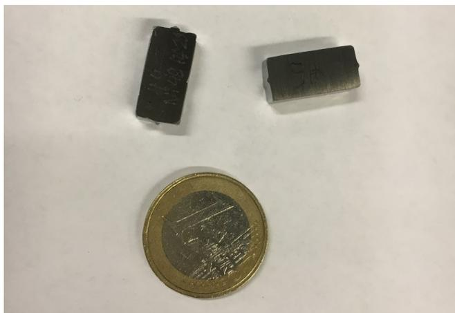
Was danach mit den Proben geschieht wissen wir hier nicht genau. Nur, dass sie in einem Ofen bei 1000°C über 100 Stunden gegläht werden.
