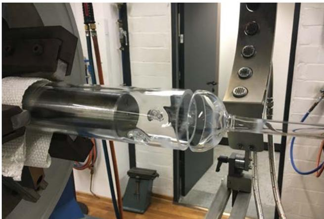
Oben rechts im Bild sieht man den vorbereiteten Boden. Bei dieser Vorgehensweise brauchen wir das Quarzrohr nur noch zusammensetzen und das kleine Halterrohr abziehen.
