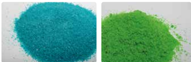
Nickelsulfathexahydrat und Nickelchloridhexahydrat (v.l.) können erneut zur Herstellung von Akkumulatoren oder für andere Zwecke Verwendung finden.
