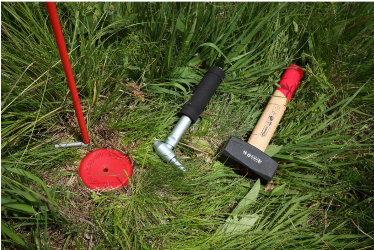
Abbildung 16: Dauerbeobachtungsflächen werden durch in den Boden geschlagene Vermessungsmarken an der Südwestecke gekennzeichnet, rechts daneben Einschlaghilfe und Schlägel. Links hinter der Marke eine der zum Abstecken der Aufnahmeflächen verwendeten Stangen.
