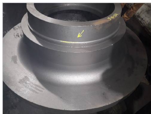
Abb. 13d: Gussteil nach der Magnetpulverprüfung
