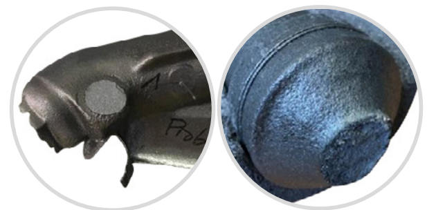
Abb. 7: Abschlagergebnis und Restspeiser des neuen Punktspeisungskonzeptes – Ein dichtes Gussteil bei dem weitere Putzarbeiten nicht erforderlich sind
