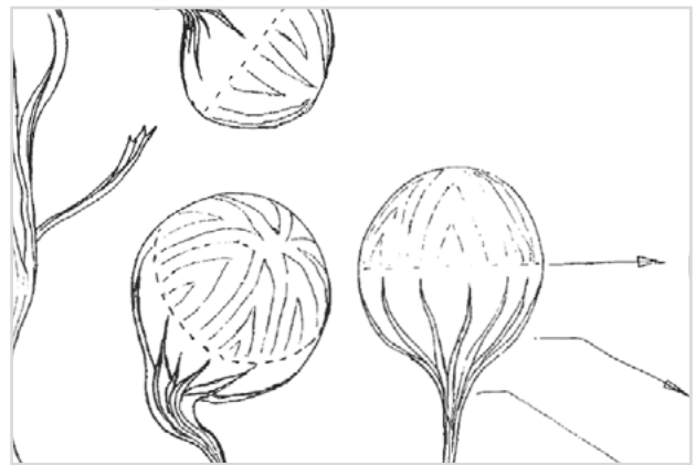
Abb. 3a: Luftblasen und Schweife von Bifilmen
