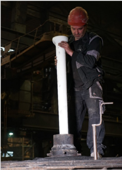
Abb. 6a: Einführung des Schutzrohrs der HOLLLOTEX Shroud in die Form
