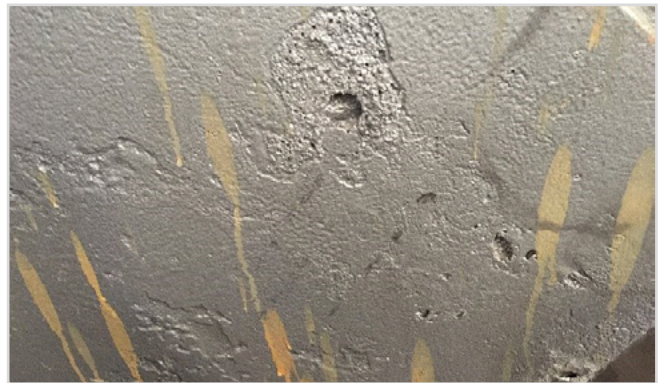
Abb. 14b: Massive Sandeinschlüsse an der Oberseite des Gussteils
