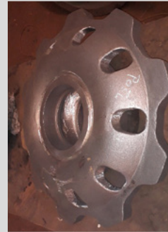
Abb. 12c: Magnetpulverprüfung nach dem Abschrecken
