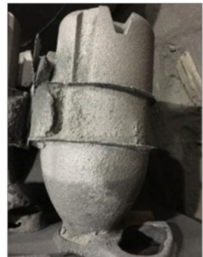
Abb. 6: Abgegossener Speiser - Modul 6,8 cm
