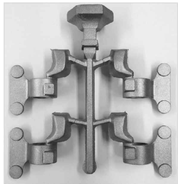
Abb. 10: Träger aus GJS - Verbessertes Handling und Einsatz feinerer SEDEX ULTRA Filter
