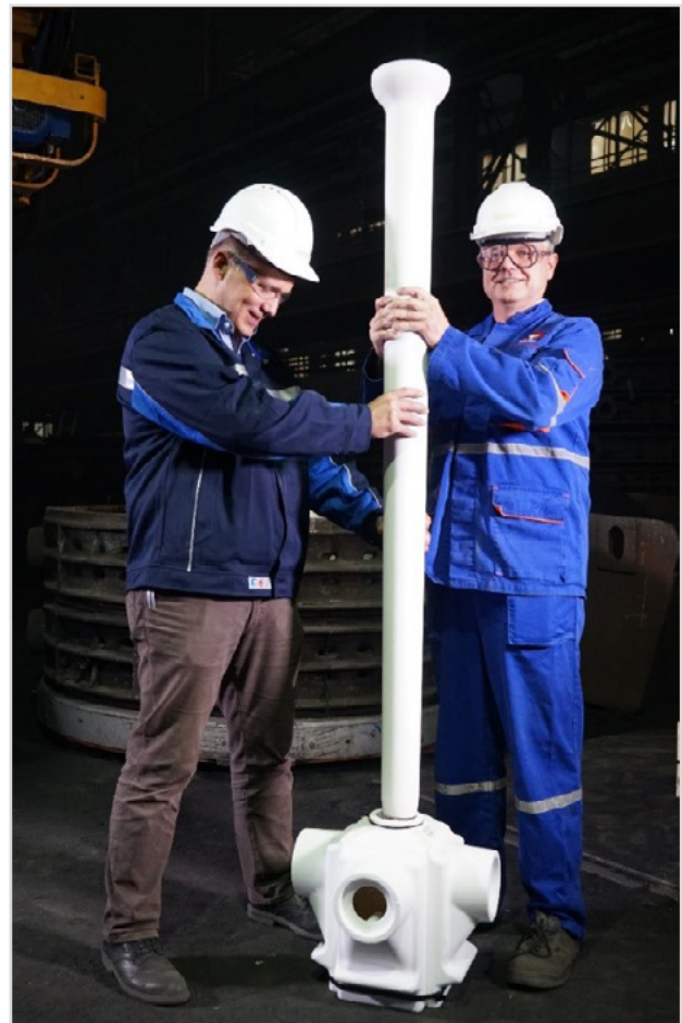
Abb. 4b: Das Schutzrohr der HOLLLOTEX Shroud reicht in das Filtergehäuse
