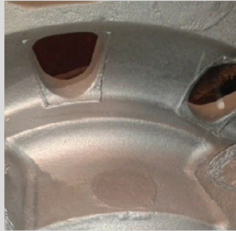
Abb. 12b: Oberfläche des Gussteils im oberen Bereich nach dem Strahlputzen
