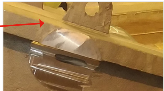
Abb. 17b: Oberfläche frei von Sandstellen oder Gasblasen
