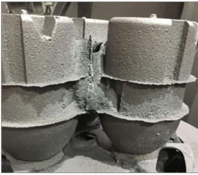
Abb. 7: Speiseranordnung - drei Speiser - Modul 6,8 cm
