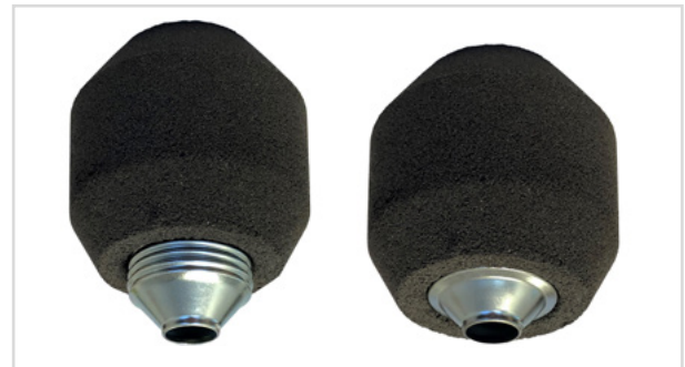
Abb. 5: Neues Speiserkonzept vor und nach der Verdichtung – typischerweise mit 8 - 15mm Abstand zwischen Speiser und Gussteil
