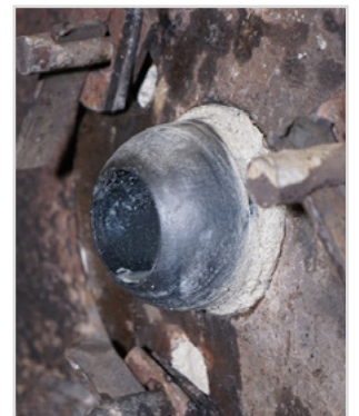
Abb. 9b: Der in der Pfanne installierte Ausguss gebrauchsfertig montiert
