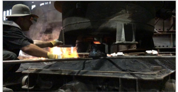
Abb. 8b: Die Pfanne befindet sich in Gießposition. Durch Drehen des Hebesystems mit Hilfe von Stahlrohren wird das Schutzrohr mit dem Ausguss dicht verbunden
