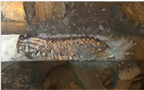
Abb. 14a: Typische Gasblasen an der Oberseite des Gussteils
