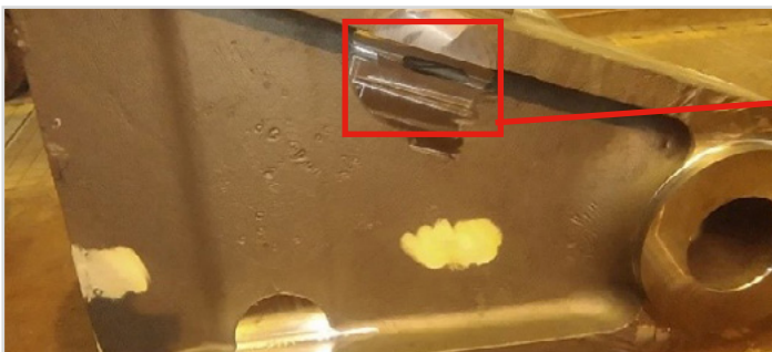
Abb. 16a: Oberfläche des mit HOLLLOTEX Shroud gefertigten Gussteils
