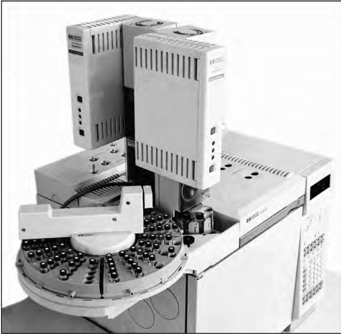
Abb. 7: Gaschromatograph mit Autosampler
