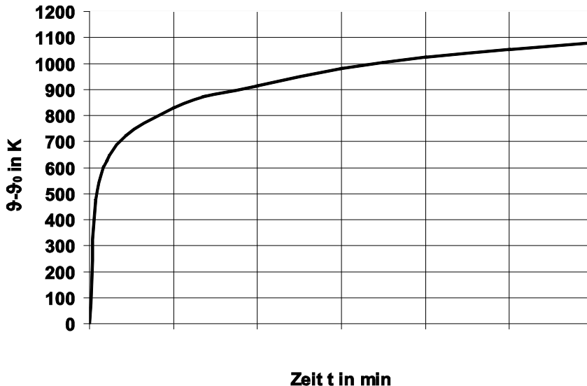
Abb. 14: Einheitstemperaturzeitkurve (ETK) nach DIN 4102
