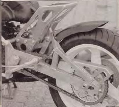
Das angeschraubte Aluheck nimmt die progressiv arbeitende Umlenkhebele des Federbeins und den Fahrersitz auf
