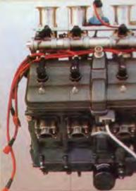
No hay comparación posible. El prototipo de motor Ferrari para una 750 deportiva está anticuado antes de pasar a la serie: los cilindros independientes y la cadena de distribución central son cosa del pasado. El V-8, las válvulas radiales, la distribución por cascada lateral... ese es el futuro.
