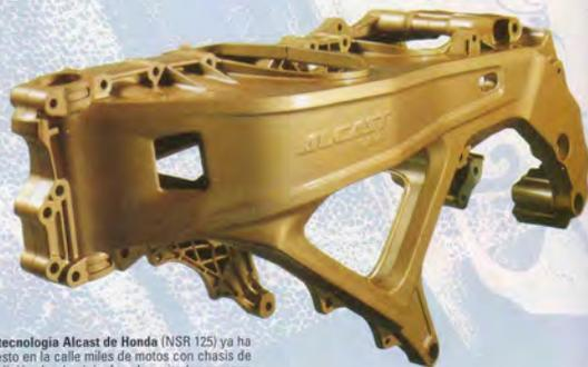
La tecnología Alcast de Honda (NSR 125) ya ha puesto en la calle miles de motos con chasis de fundición de aluminio. Las dos mitades se unen mediante tornillos simplificando el proceso de fabricación.
