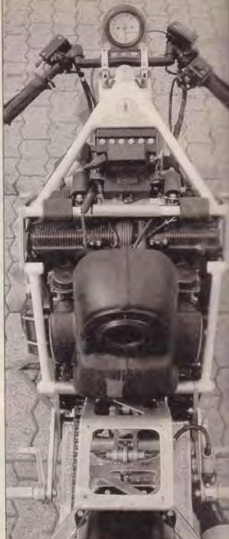
Das Stahrohrgeflecht hat nur Hilfsfunktion, fast sämtliche Kräfte nimmt der Motorblock auf
