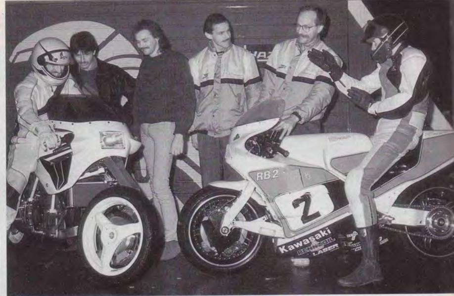
Rennmaschine. Als Werkstoff für Schwinge und Achsschenkel verwendeten die Holländer Stahlblech, so konnten die Querschnitte kleiner bleiben und der ganzen Vorderradaufhängung ein ansprechendes Äußeres gegeben werden. Selbstentworfen, dreiteilige Räder und ein kunstvoll aus dem vollen gefräster Hilfsrahmen, der auch die hintere Einarmschwinge aufnimmt, zeugen von viel Liebe zum Detail. Die RB 2 zeigt, daß Achs-
