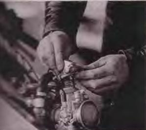
bitterkalten Montag in Hockenheim für die Foto- und Meßfahrten starten will. Der ungewohnt links montierte Kickstarter ist sehr kurz übersetzt. Erst angeschoben und mit dem zusätzlichen Schub eines Helfers springt der eiskalte Einzylinder ins Leben: „Ich experimentiere zur Zeit mit einem 38er Dellorto-Vergaser, um die Startschwierigkeiten zu beseitigen“, keucht Holger. Dieser sorgt ohne den nun fehlenden Luftfilterkasten allerdings für ein recht kerniges Ansaugröhren.
