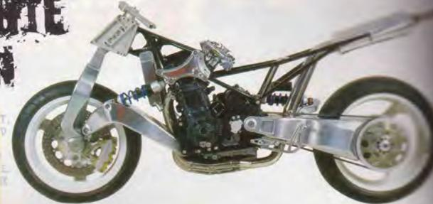
Welches Bauteil ist das: Es muß mühselig bei Sonnenschein und Regen mit der Hand geschmiert werden, verdeckt das Motorrad, will alle 1000 Kilometer nachgestellt werden und ist nach 20.000 Kilometer teurer Schrott? Wenn heute noch Motorradmotoren
