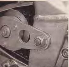
Das zusätzliche Wälzlager an der Abtriebswelle entlastet die Getriebebelagerung
