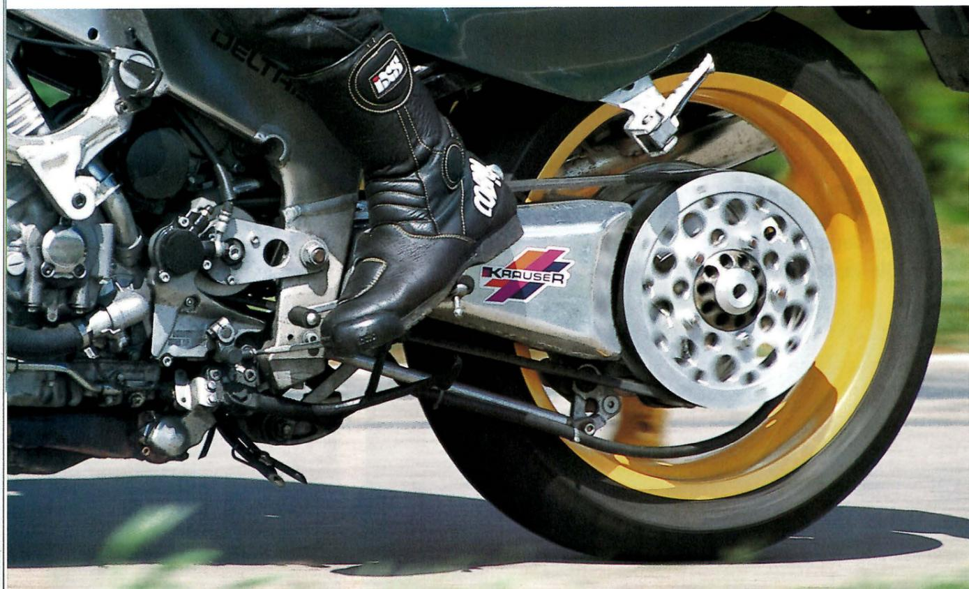
Raffiniertes Riemenwerk. Die patentierte VH-Schwinge mit automatischem Längenausgleich wurde für die Yamaha-Produktplanung gebaut
