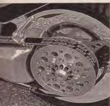
Voluminöse Einarmschwinge mit dem 37 Millimeter breiten Zahnriemen
