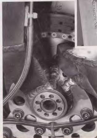
**Die Radlagerung im Achsschenkel ist deutlich zu sehen, von der Schwinge verdeckt: der Kugelkopf**
