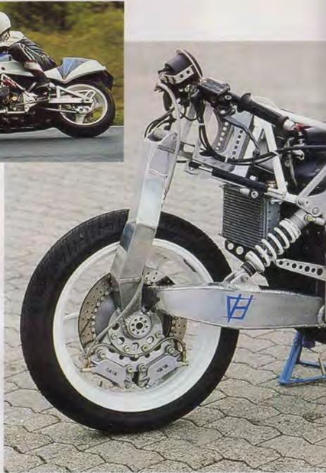
**Südfrucht:** Mit zwei Schwingenarmen führt Bimotas Tesi ihr Vorderrad. Gelenki wurde zunächst per Hydraulik, später über Spurstange
