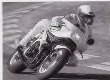
Der Rahmen umfaßt den Motor; die Verbindung von Lenkkopf und Schwingenlager ist sehr direkt. Das ist Leichtbau: 171 Kilogramm trocken, 191 fahrfertig
