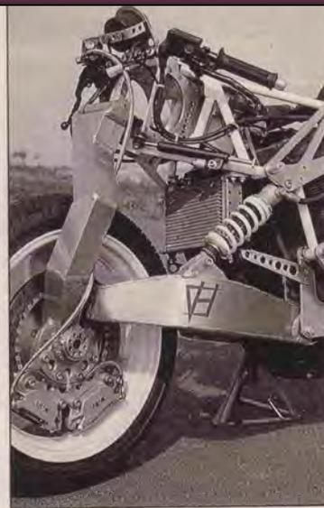
Der Prototyp der VH-Suzuki hat noch einen Hilfsrahmen aus Stahlrohr und Alu-Platten. Später soll ein entsprechend ausgelegtes Motorgehäuse den Rahmen ersetzen. Der Achsschenkel wird an zwei Längslängskern geführt
