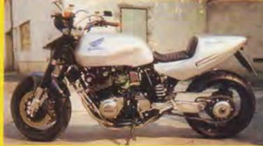
Teleskop kann jeder. Aber bekannt geworden ist die Firma VH-Motorradtechnik zum Glück ja auch durch die innovativen Fahrwerkskonzepte. Und das hat Tradition. Bereits 1984 entstand als Ersatz für die allerersten, damals noch butterweichen GSX-R 750 und 1100-Alu-Fahrwerke ein eigenes Gitterrohrfahrwerk, das im gleichem Gewicht eine viermal höhere Torsionssteifigkeit aufwies als das Original. Diese VH-R 750/1100 wurde von 1987 bis 1990 in kleiner
