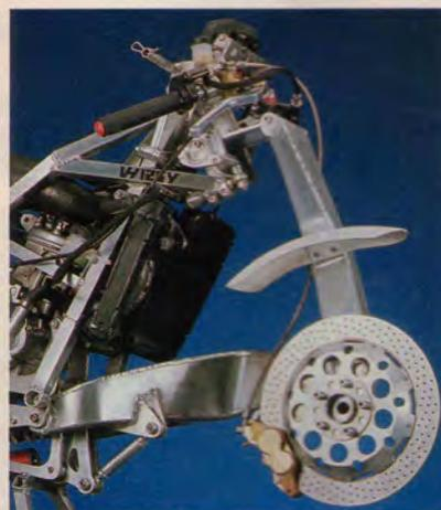
Front: Alu-Achsschenkel, 310-Millimeter-Bremsscheibe
