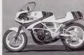
Sehr steifer Gitterrahmen aus Stahlrohr, feinste Zutat, allerdings auch stolzer Preis: Für 20 000 Mark ein starker Renner für die Straße
