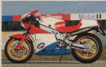
Die Verkleidung und der Höcker sind angepaßte Nachbauteile der Honda RS 250. Den Aluminium-Tank hat Holger Rattay selbst gedengelt
