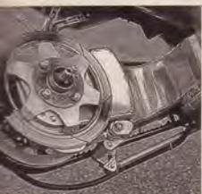
Über Umlenkhebel stützen sich Radaufnahme und Bremsanker am Rahmen ab
