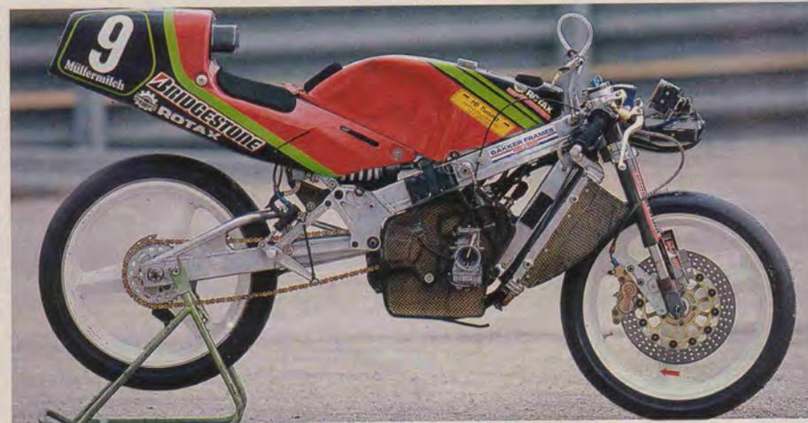
Der Rahmen kommt aus Holland, der Drehschieber-Werksmotor aus Österreich: Bakker-Rotax von Peter Öttl
