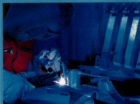
Schweißtreibend: Anbringen des Halters am Aluminium-Steinschlagschutz
