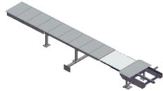
**Grubenabdeckung:** Pneumatisch oder elektrisch verfahrbare Abdeckung der Werkergube unterhalb des Fahrzeugs. Die Abdeckung kann auf Wunsch überfahrbar ausgeführt sein.
