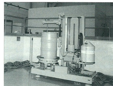
g-Scanner zum Ausmessen von 200-Liter-Abfallfässern in der Landessammelstelle. Foto: VKTA Rossendorf e.V.
