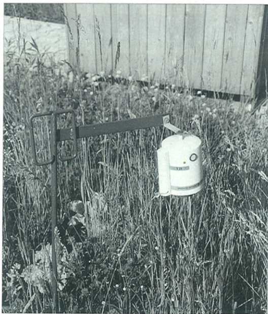
Aufwendige Meßtechnik, erfahrene Mitarbeiter: Die Umgebungsüberwachung und der Strahlenschutz genießen im VKTA Rossendorf e.V. höchste Priorität. Bild links: Dosimeter zur Bestimmung der Gamma-Ortsdosis in der Umgebung. Bild rechts: Wassermeßstelle am Kalten Bach.
