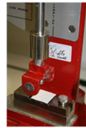
Pendel sowie Grundplatte des Probenträgers mit gespaltener Probe
