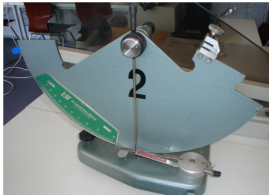
Abb.: Prüfgerät zur Bestimmung der Durchreißfestigkeit
