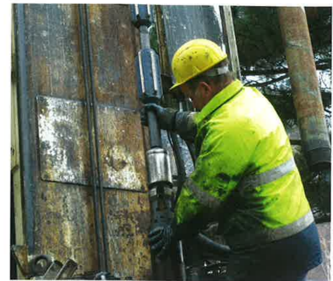
Abb. 9 – Das Innenrohr hängt am Overshot
