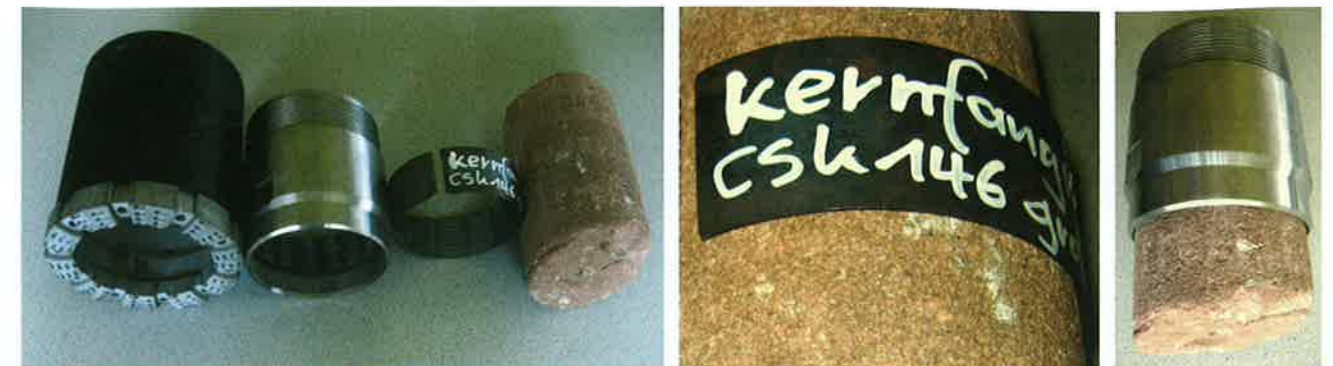
Abb. 16 – Krone, Kernfanghülse, Kernfangring, Bohrkern: Die Grundlagen des Kerngewinns
