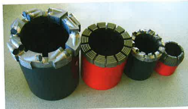
Abb. 13 – Durchmesserstaffelung der Seilkernrohr-Bohrkronen
