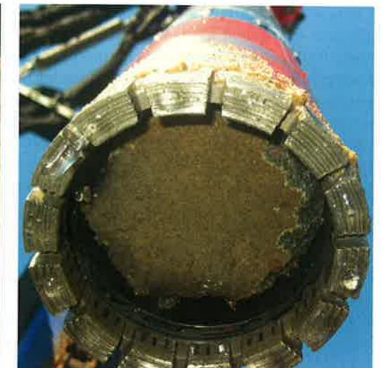
Abb. 4 – Doppelkernrohrkrone mit darin enthaltenem Kern
