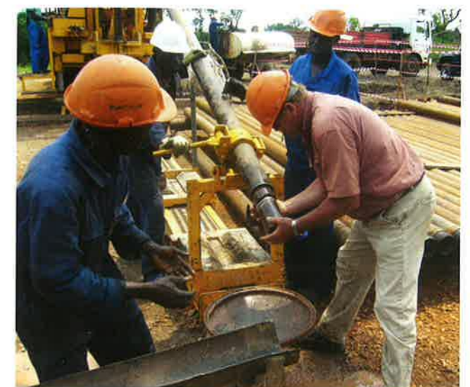
Abb. 10 – Kerngewinnung und Ablage
