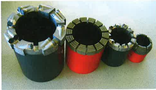
Abb. 13 – Durchmesserstaffelung der Seilkernrohr-Bohrkronen
