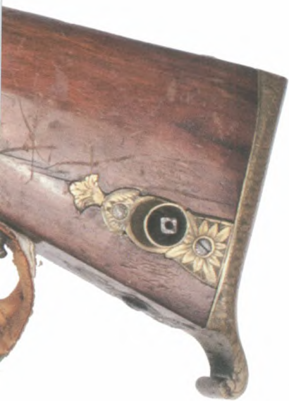
Detailansicht einer Windbüchse Österreich, um 1850 von Dasch in Graz gefertigt Vierkant zum Spannen der Windlade, Stecherabzug Grifflaub mit drei Fingerrillen davor Entriegelungshebel zum Abkippen des Laufes Daumenauflage mit Fischhaut (geriffelte Fläche) oNr/3.644
