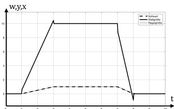
Abbildung 7: Rampenförmige Anregung des Regelkreises aus Beispiel 1 mit dem Sollwert w (gestrichelt), der Stellgröße y (fett, durchgezogen) und der Regelgröße x (dünn, durchgezogen)
