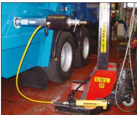
◀ Ein RACH-306, angetrieben von einer P-392 Handpumpe, dient zum Herausziehen korrodierter Karosseriezapfen aus Entsorgungsfahrzeugen.
