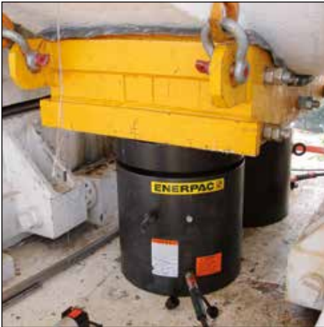
▲ Schwerlasthubanwendung und Fundamentausrichtung. Stelling gewährleistet sicheres mechanisches Halten der Last, auch über einen längeren Zeitraum.
