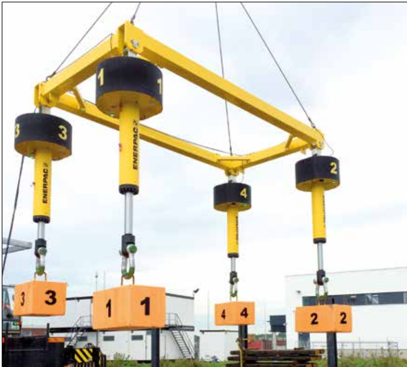
▼ Das autonome SyncHoist-System SHAS 411040WE bei einer Lastsimulation
