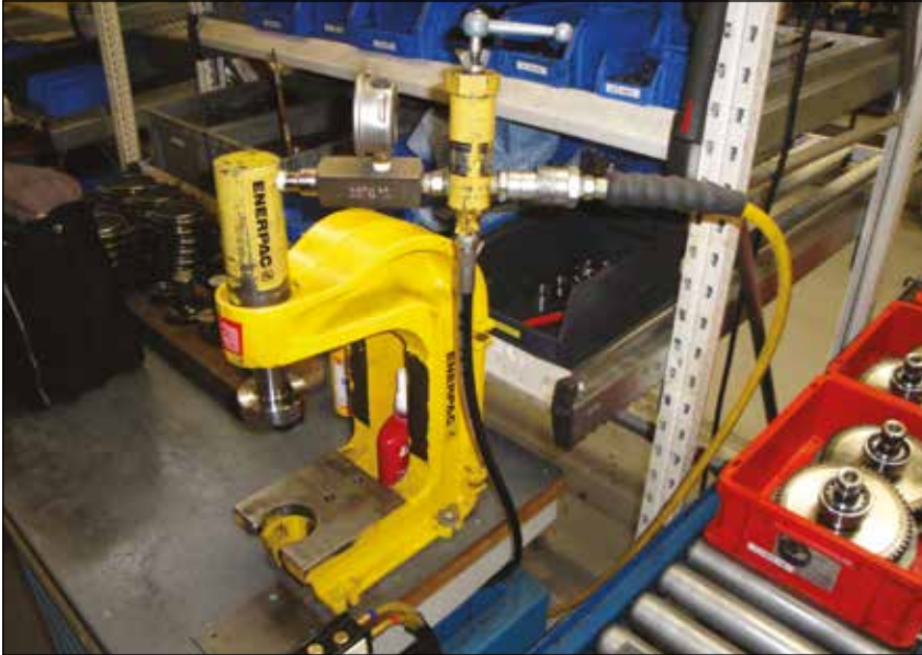
▲ RC-308-Zylinder, montiert in Dornpresse, angetrieben von einer PATG Turbo Air-Pumpe zum kontrollierten Herauspressen der Lager für Kettenräder von Webmaschinen. Das V152-Druckbegrenzungsventil steuert die Presskraft.
