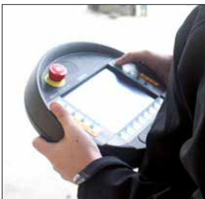
▼ Ein einzelner Bediener steuert und überwacht mit der drahtlosen Fernbedienung aus sicherer Entfernung den gesamten Hebevorgang.
