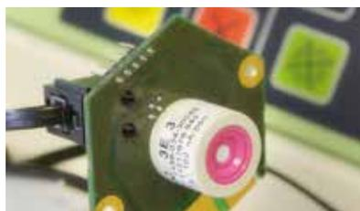
Sensor für Säuredetektion
