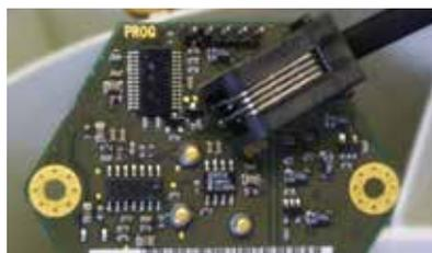
Sensor für Lösemitteldetektion
