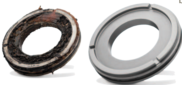
Werkstück vor und nach dem Entfetten
