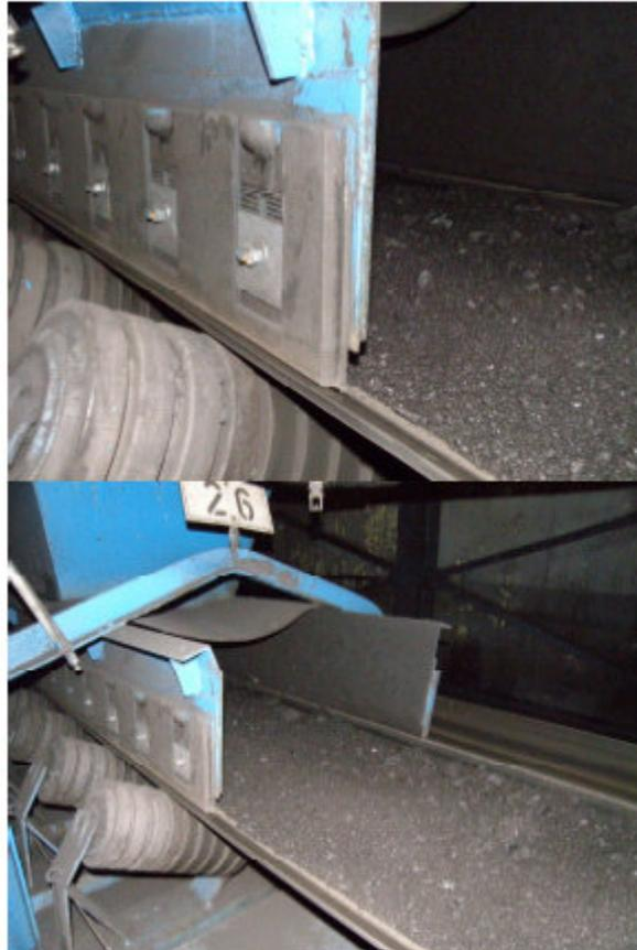
Die Segmente können einzeln auf Gurtkontakt, bzw. dicht an den Gurt heran gestellt werden. Dazu müssen die Muttern der Klemmplatten gelöst werden. Mit einem Hammer kann das betreffende Segment dann nach unten geschlagen werden. Als Schlagzone dient die Nase an der Oberkante der Segmente.
