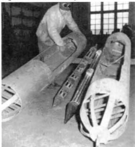
Dahlbusch-Rettungsbomben und die in Lengede benutzten Versorgungsbomben.
