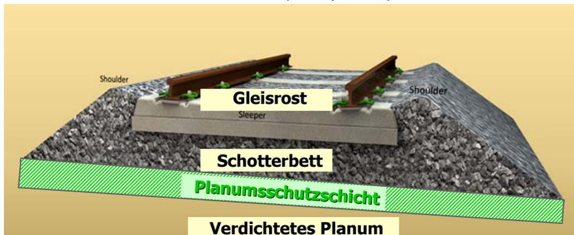
Hauptaufgabe der → **Planumsschutzschicht** innerhalb der Gesamtkonstruktion:
