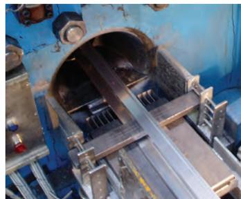
Auslässe von Aluminium-Extrusionspressen
