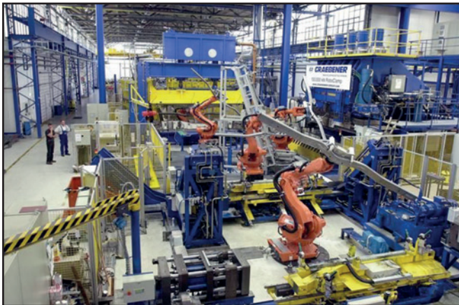
Abb. 13: Roboterlinie und Hydroforming-Presse der 2016 ausgelieferten Fertigung von Längsträgern für Land Rover in der Finow Automotive GmbH. Finow Automotive Archiv, Eberswalde-Finow.
