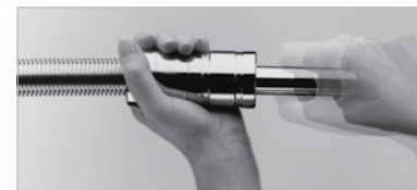
4. Klemmbacken schließen. Durch Bewegen des Schlagbolzens die Welle zu einem Bördel anstauchen.
