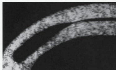
Bild 7.6 Spaltkorrosion an einem Kaltband aus austenitischem Stahl. Schnittbild (50-fache Vergrößerung).
