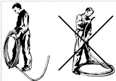
Bild 4.7.1 Sachgerechtes (links) und fehlerhaftes Auslegen (rechts) von Schlauchleitungen
