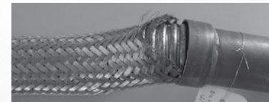
Bild 4.1.3 Geflechtsversagen an der Einbindung
