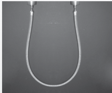
Bild 4.1.6 Biegelinie im U-Bogenversuch unter Innendruck.
