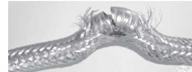
Bild 4.1.2 Geflechtsversagen und anschließender Schlauchbruch
