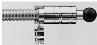
3. Klemmbacken bei zurückgezogenem Schlagbolzen öffnen. Wellenschlauch mit dem zweiten Wellental in Klemmbacke legen.
