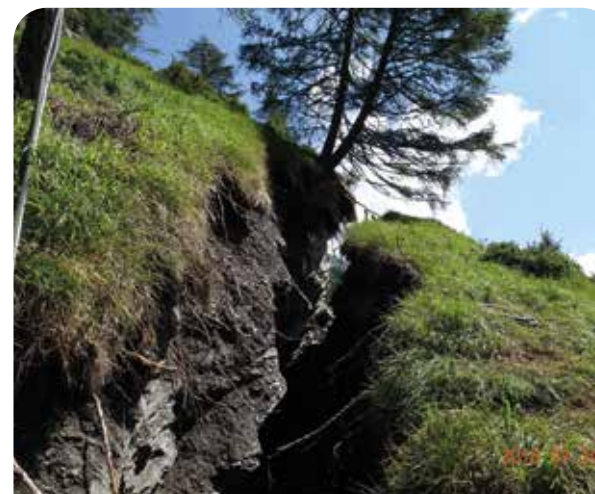
Abbildung 8: Links: Hauptzugriss westlich der Abbruchsnische 2017. Rechts: Rissmesser im Hauptriss
