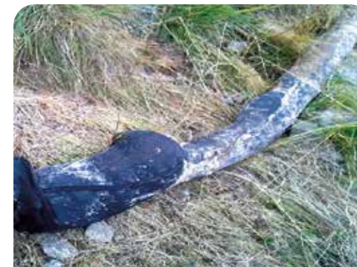
Abbildung 2: Beispiele für tragfähigkeits- und gebrauchstauglichkeitsrelevante Schäden an Mikropfählen; Ausziehen eines Mikropfahles (links); Bruch eines Mikropfahles im Kopfbereich in Folge eines Treffers (rechts)
