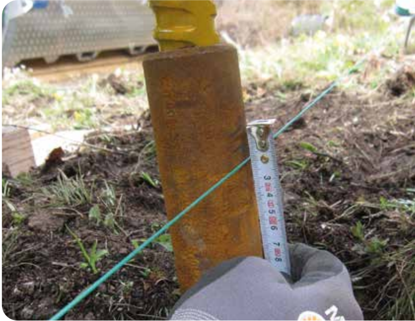
Abbildung 2: Die zwei am häufigsten eingesetzten Methoden zur Bewegungsmessung: Messschnur orthogonal zum Zugerät (Bild oben), Stativ mit Messuhr (Bild unten)
