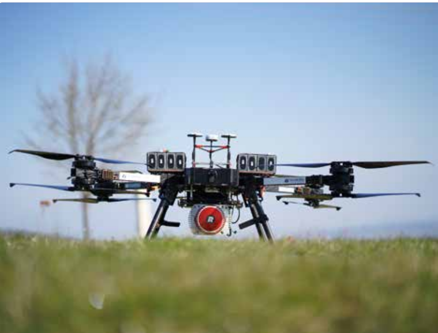
Abbildung 4: Zur Befliegung verwendete Drohne mit montiertem Laserscanner
