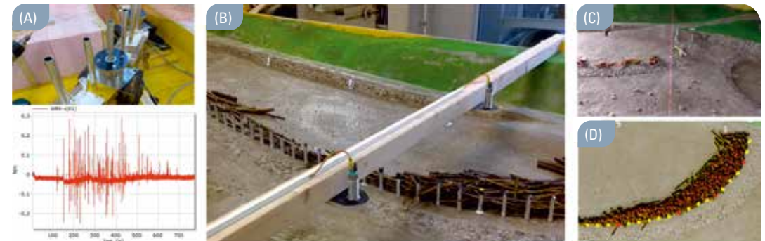
Abbildung 4: (A) Rechenelement mit Dehnmessstreifen, darunter sind Rohdaten der Aufnahme ersichtlich. (B) Ultraschall zur Messung des Wasserspiegels. (C) Laser zur Erfassung der Kubatur der Holzablagerung. (D) Höhenmodell der Ablagerung
