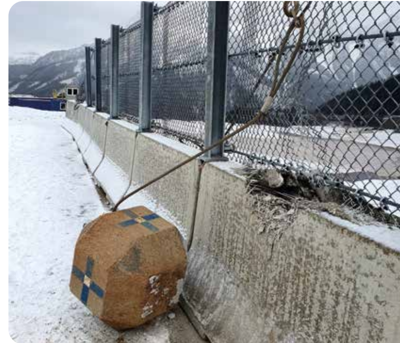
Abbildung 3: Testversuch in die Betonleitwand
