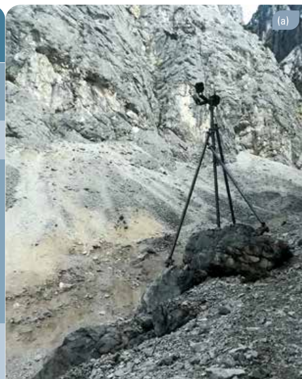
Abbildung 3: Bettelwurfmure, a) Monitoringmessstelle – Mitte, Ausstattung: 2 TCL-Zeitrafferkameras, eine ICUSERVER Wildkamera b) hochgenaues digitales Höhenmodell auf Basis einer UAV-Befliegung im Juni 2020
