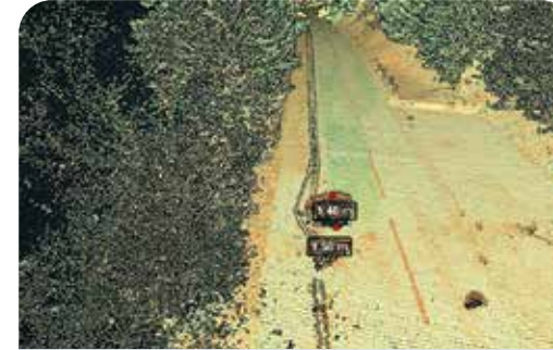
Abbildung 8: Screenshot des Online-Tools zur Ansicht der Punktwolke - Bildausschnitt im Bereich 2 der Übersichtskarte. Klar ersichtlich die beiden Blöcke sowie die verbogene Leitplanke.
