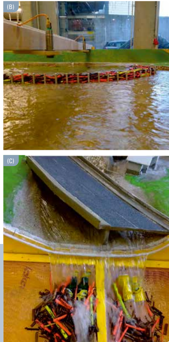
Abbildung 3: (A) Die drei verwendeten Wildholzlängen welche in der Natur einer Länge von 2 m, 4,5 m bzw. 7,2 m entsprechen; (B) Beispiel der Verteilung der verschiedenen Wildholzstücke bei voll verklautem Rechen; (C) Auffangbehälter nach dem Modell zur Auswertung der Durchlässigkeit des Rechens
