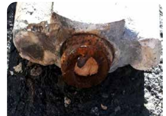
Abbildung 2: Beispiele für tragfähigkeits- und gebrauchstauglichkeitsrelevante Schäden an Mikropfählen; Ausziehen eines Mikropfahles (links); Bruch eines Mikropfahles im Kopfbereich in Folge eines Treffers (rechts)
