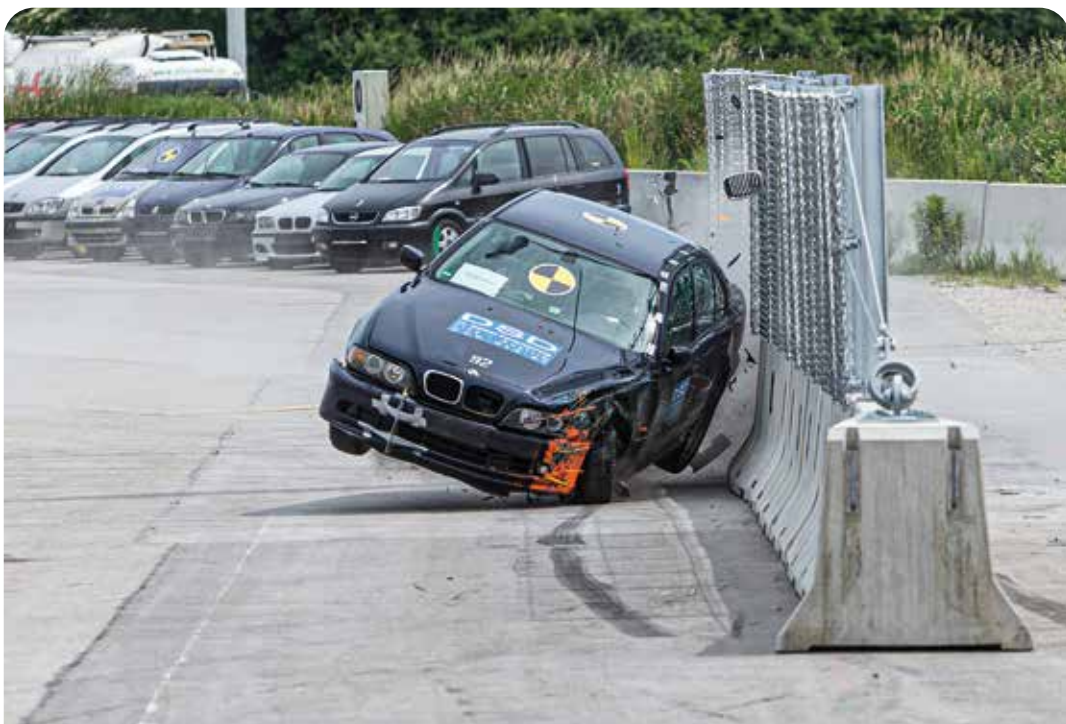
Abb. 5: Erfolgreicher TB32 Anpralltest am Versuchsgelände in Allhaming
