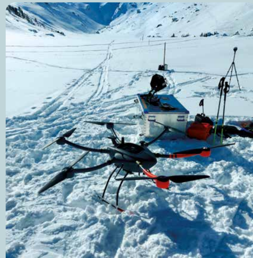
Abbildung 1: Höhenarbeit Sprengdrohne, Transportkiste und Steuerung (9. März 2021, Stefan Lindner – BFW).
