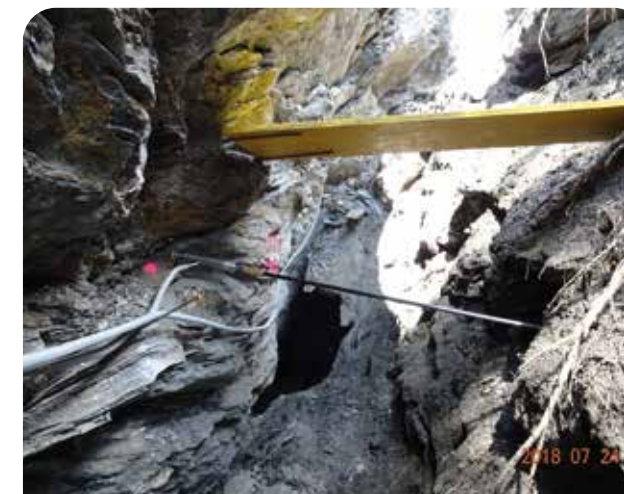
Abbildung 8: Links: Hauptzugriss westlich der Abbruchsnische 2017. Rechts: Rissmesser im Hauptriss
