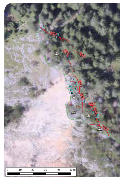
Abbildung 5: Lage der Fissurometer 1 - 9 oberhalb der Pürgger-Wand im Bereich der Zerrklüfte am Plateau
