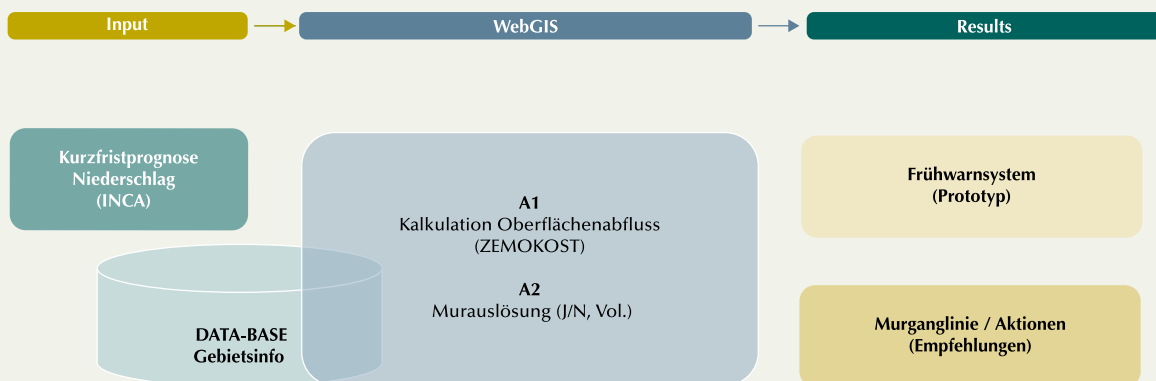
Abbildung 1: Schema des in INADEF entwickelten Frühwarnsystem-Prototyps
