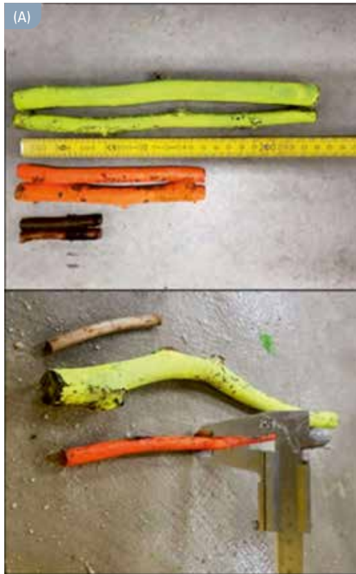
Abbildung 3: (A) Die drei verwendeten Wildholzlängen welche in der Natur einer Länge von 2 m, 4,5 m bzw. 7,2 m entsprechen; (B) Beispiel der Verteilung der verschiedenen Wildholzstücke bei voll verklautem Rechen; (C) Auffangbehälter nach dem Modell zur Auswertung der Durchlässigkeit des Rechens
