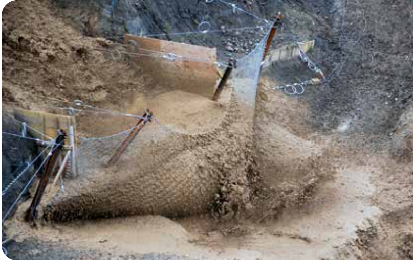
Abbildung 1: Großfeldversuch der Hangmurenbarriere in Veltheim/Schweiz.
