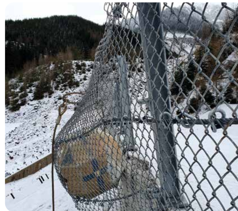
Abbildung 4: Testversuch in den Netzverbau
