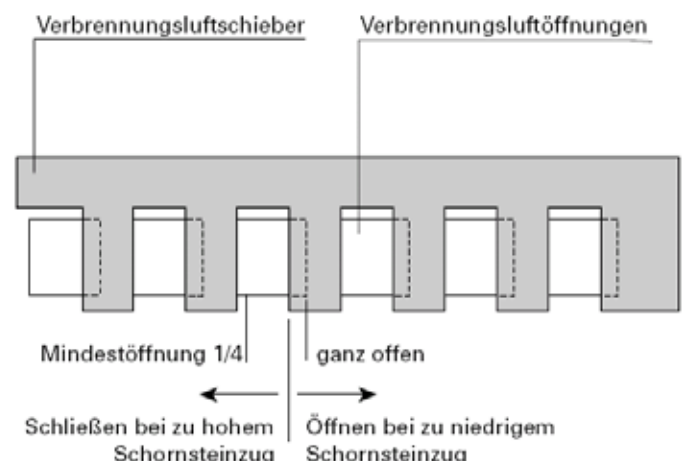
Abb. 13: Anpassen Verbrennungsluftquerschnitt
