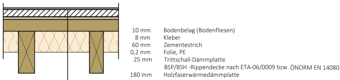
Abbildung 2.38 gewählter Fußbodenaufbau [16]
