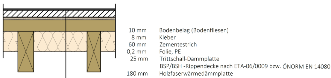
Abbildung 2.3 gewählter Fußbodenaufbau
