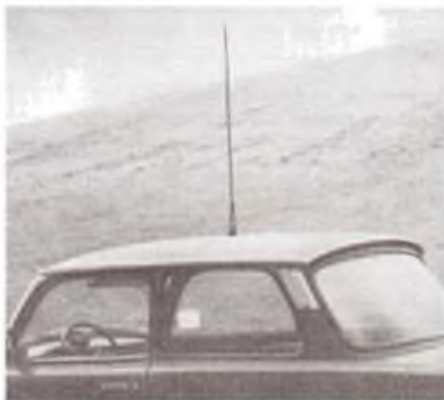
Bild 3: Optimale Variante für die Antenne: In der Mitte des Daches
