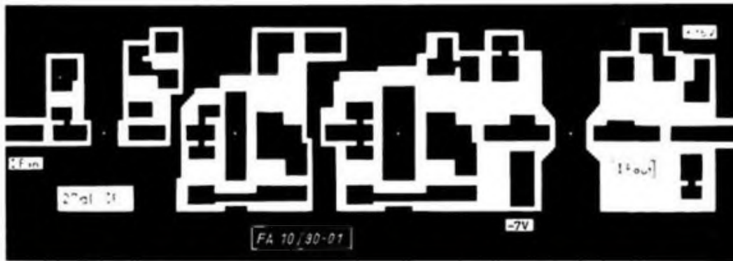
Bild 3: Leitungsführung der Platine im Maßstab 2:1
