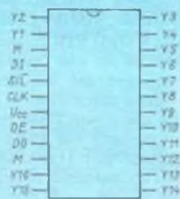
Bild 2: Anschlußbelegung des D 718 (entspricht UAA 2022)
