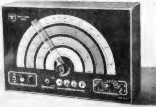
Der jahrelang bestens bewährte Meß-Sender mit leichter Bedienbarkeit. Genauigkeit besser als 1 Promille. 220V ~ / 3 Röhren. 100 kHz bis 15 MHz. Hf-Spannung 1:100000 regelbar. Glimmlampenkontrolle der Osz.-Anodenspannung. Leicht. Einbau in Arbeitsplätzen
