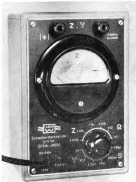
Bild 8. Außensicht des Scheinwiderstandsprüfers
