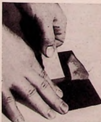
Bild 10. Strip-Fertigungsprozess; Die überflüssige Cu-Folie wird hier von Hand abgezogen, so daß nur das gewünschte Leitungsbild auf der dielektrischen Platte zurückbleibt. Auf der gegenüberliegenden Seite der Platte bleibt die Cu-Folien-Auflage unverändert
