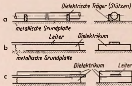
Bild 2. Ausführungsformen unsymmetrischer Microstrips; a = einfacher Rundleiter, b = gedruckter Microstrip, c = Sandwicheiter (Kupferband zwischen zwei Dielektrika eingebettet)
