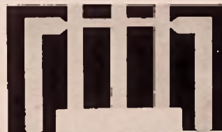
Bild 14. Dreiteiliger Bandpaß in symmetrischer Strip-Line-Technik
