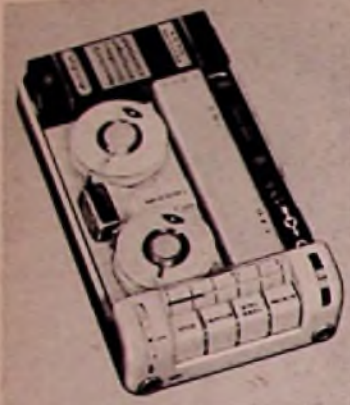
Bild 4. Innenansicht des Taschen-Drahttongerätes „Minifon P 55“ (Protona GmbH)
