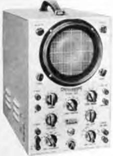
12,5-cm-Bildröhre mit Fluoreszenzschirme und kontinuierlicher Helligkeitsregelung, Strahlverschiebung horizontal und vertikal, Rücklaufaustastung, Helligkeitsmodulationsanschluß, Eichspannung, 50 Hz und Sägezahnungsgang. Technische Daten: Vertikal: Gleichspannungs-Gegentaktverstärker 0-5 MHz (verwandelbar bis 10 MHz) 10 mV/cm, 4fach Frequenzkomp.
