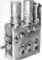
**UHF-Tuner**, mit den Röhren PC 86 und PC 88, ZF = 38,9 MHz, entspricht der allgemein bekannten Ausführung, für alle moderneren Empfängertypen. 43.—
