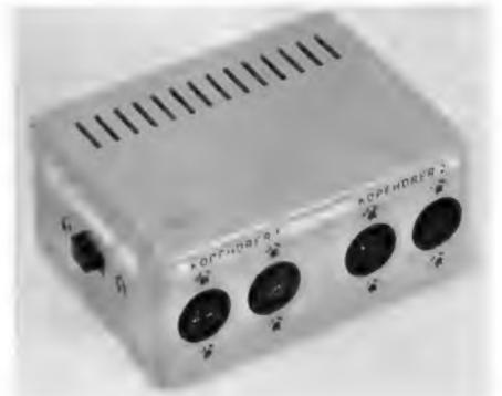
Bild 2. Umschaltgerät für Kopfhörerniedergabe UG 8
