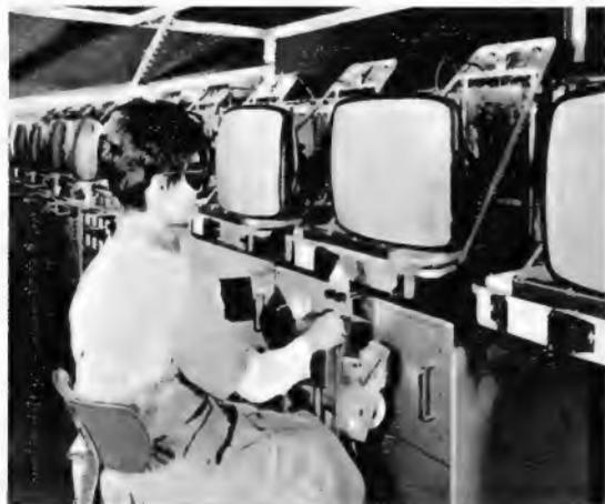
Prüfautomat im Bildröhrenwerk Eßlingen der SEL
