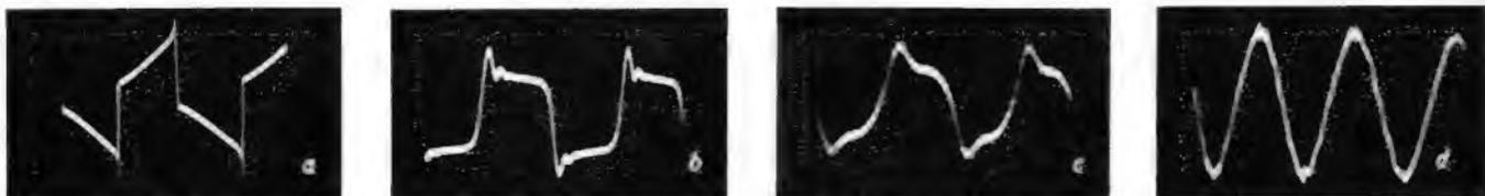
Bild 1. Schirmbilder eines Rechteckimpulses nach Aufnahme und Wiedergabe über ein halbprofessionelles Tonbandgerät, a = 100 Hz, b = 1 kHz, c = 5 kHz, d = 10 kHz
