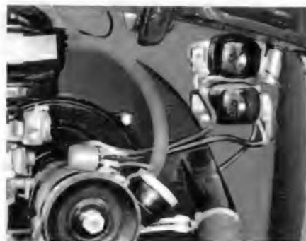
Bild 1. Blick in den Motorraum des VW 1200 mit 12-V-Anlage und Batterie-Trennrelais (oben rechts)
