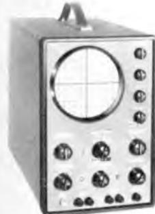
Universal-Oszillograph mit 3stufigem Gegentakt-Gleichspannungs-Verstärker großer Empfindlichkeit. Kompensierter 4stufiger Abschwächer, 12,5 cm Kathodenstrahlröhre, direkte Anschlußmöglichkeit der Vertikalplatten, Rücklaufaustastung und Synchronisationswählschalter, Rechteckvergleichsspannung. Lochblechgehäuse grau mit Frontrahmen. Technische Daten: Vertikal: 3,5 mV/eff cm, 0-500 kHz
