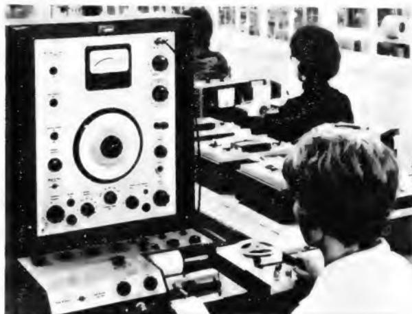
Die Pegelschreiber-Anlage in der Endkontrolle der Uher-Tonbandgeräte-Fertigung
