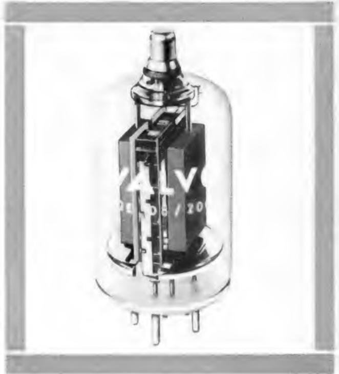
Die Leistungstetrode QE 08/200 ist geeignet für hochwertige Verstärker im NF- und HF-Bereich. Wegen des günstigen Verlaufes der  $I_A$ -,  $U_A$ -Kennlinien, auch im Bereich niedriger Anodenspannungen, lassen sich Endstufen mit guter Linearität für den Leistungsbereich 200 W bis 300 W aufbauen.
