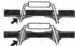
Bild 4. Bei zweiseitig beschichteten Platinen mit Durchplattierung (unten) kann das Zinn die Anschlußdrähte besser umfließen
