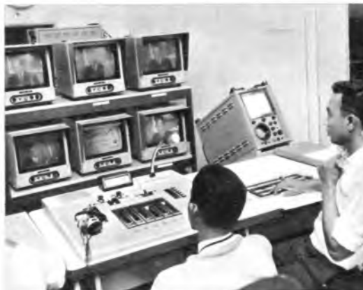
Bild 2. Blick in den Kontrollraum A, in dem die Sendeablaufregie untergebracht ist
