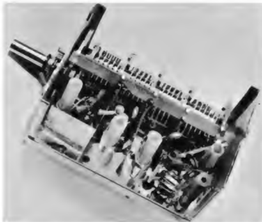
Bild 1. Ansicht des UKW-Tuners mit Feldeffekt-Transistoren und Vierfach-Drehkondensator (Görler)
