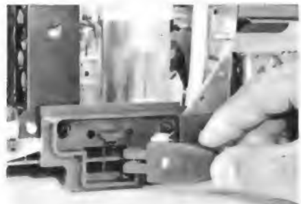
Bild 8. Der Fernbedienungsstecker wird direkt auf die zweiseitig beschichtete Leiterplatte aufgesteckt
