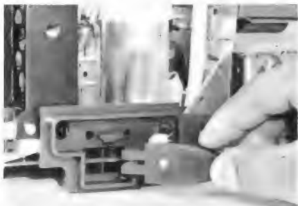
Bild 8. Der Fernbediensteker wird direkt auf die zweiseitig beschichtete Leiterplatte aufgesteckt
