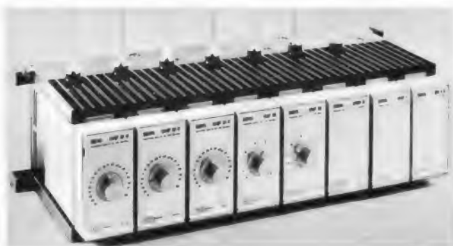
Seva-Steckweiche bestückt mit abstimmbaren Verstärkern (3 × UHF, 2 × Bereich III), Bereichsverstärkern für UKW und VHF I sowie dem Breitband-Endverstärker 47...790 MHz (Aufnahme: FTE maximal)
