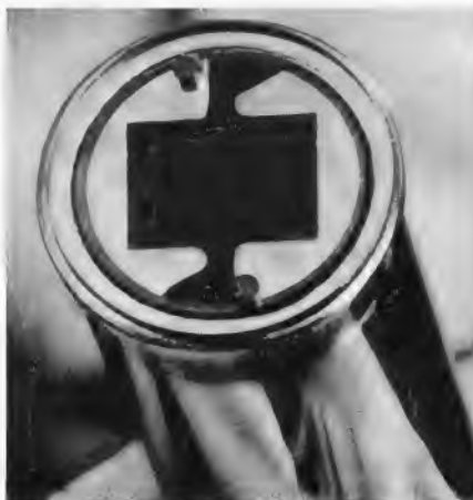
Fernsehaufnahmeröhre Typ Bivicon der RCA Corp. mit zwei Targets und Doppelstrahl-Abtastung. Blick auf das Zweifach-Target
