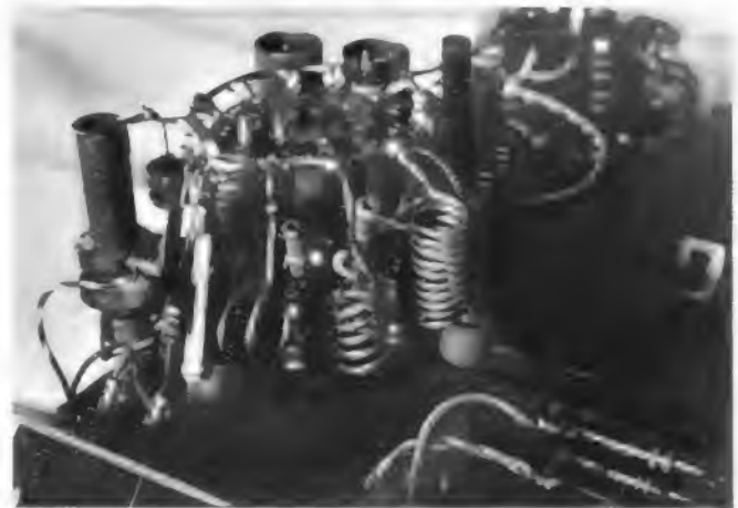
▲ Bild 20. Aufbau des FET-Verstärkers auf einer Platine
