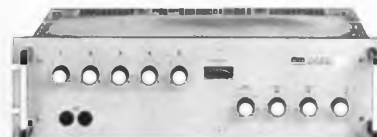
E 120 e Mono-Mischverstärker für Gestell-Einbau 19 Zoll 160 Watt Musikleistung 120 Watt Sinusleistung 0,2% Klirrfaktor
