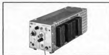
MB 140 Monoblock Mono-Endverstärker 140 Watt Musikleistung 120 Watt Sinusleistung 0,1% Klirrfaktor 0,6 V Empfindlichkeit
