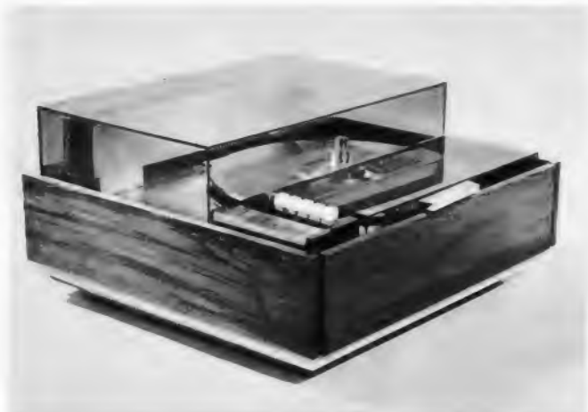
Der Einzelspieler für die MCA Disco-Vision-Bildplatte mit Abtastung der einseitig bespielten 30-cm-Bildplatten von oben. Das Gerät wird mit sechs Drucktasten bedient
