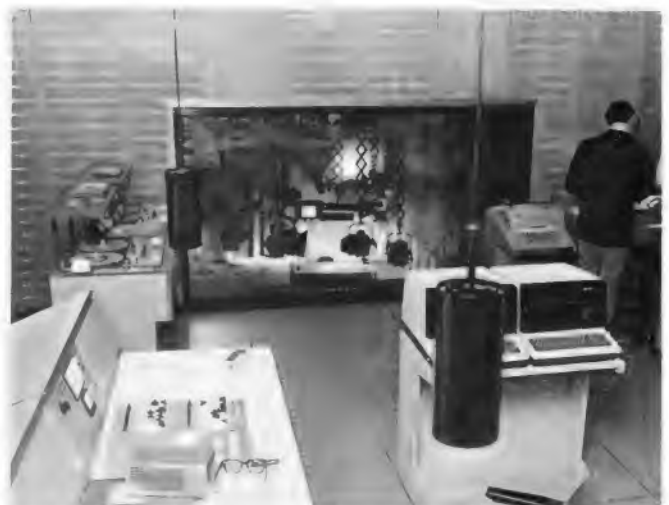
Bild 1. Blick aus der Sendekontrolle in das Ansagestudio. Links unten: Bedienteil für die Lichtstellanlage mit Kernspeicher, rechts zwei Datensichtgeräte (vgl. Bild 6)
