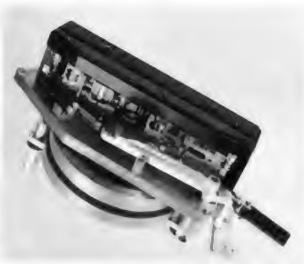
Bild 3. Das Antriebssystem ist mit dem Kopfträger und dem elektronisch geregelten, kollektorlosen Motor zu einer Einheit zusammengefaßt
