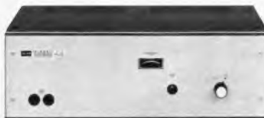
A 60 Mono-Endverstärker 80 Watt Musikleistung 60 Watt Sinusleistung 0,2% Klirrfaktor 0,6 V Empfindlichkeit
