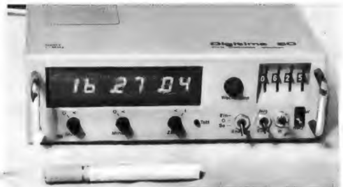
Die Gallium-Phosphid-Anzeige SLA-1, eingebaut in eine Quarzuhr
