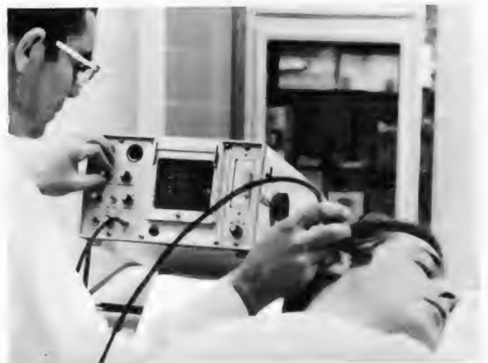
Der neue Siemens Echo-Encephalograph T ermöglicht exakte Messungen im Schädelinnern mit Ultraschall-Frequenzen zwischen 1 MHz und 6 MHz
