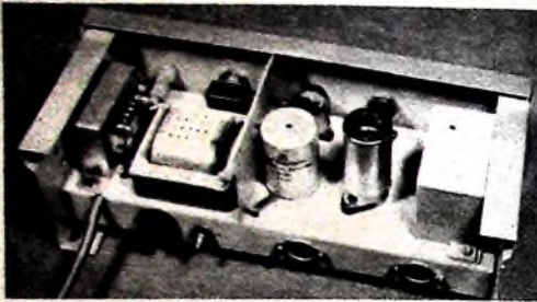
Bild 5. Rückansicht des Gerätes; die Abschirmung der Drossel Dr 2 und die Abschirmwand zwischen Netzteil und Verstärker sind gut erkennbar
