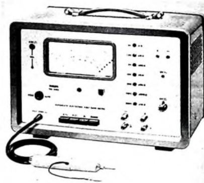
Bild 1. Volt-Ohm-Meter „PM 2405“ mit automatischer Meßbereichumschaltung
