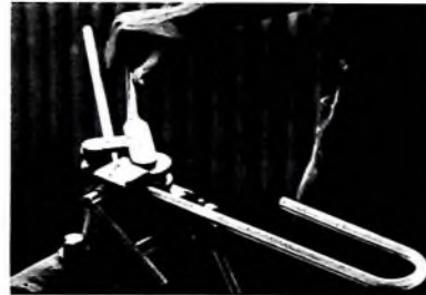
Bild 11. Einfache Biegevorrichtung zum Anfertigen von Faltdipolen
