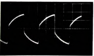
Bild 9. Nicht einwandfrei kompensierter Eingangsspannungsteiler; die hohen Frequenzen werden abgeschwächt
