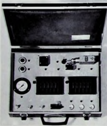
Bild 25 Experimentierkoffer für Fluidics (Knorr)
