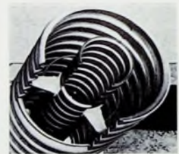
Bild 1. Das 50-Ohm-Hochfrequenzkabel „50-97/230 Al“ hat bei einem mechanischen Durchmesser von 246 mm einen wirksamen elektrischen Durchmesser von 230 mm. Bei beispielsweise 40 MHz ist die Dämpfung des Kabels 0,1 dB/100 m; die Ausbreitungsgeschwindigkeit im Kabel ist etwa 98 % der Freiwelenausbreitung.
