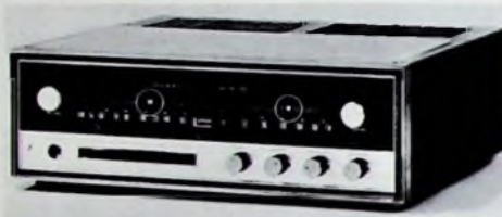
Bild 6 Rundfunkgerät mit Lichtleiter zur Skalenanzeige. An Stelle des herkömmlichen Zeigers besorgt ein Lichtpunkt des langs der Skala bewegten Lichtleiters die Anzeige
