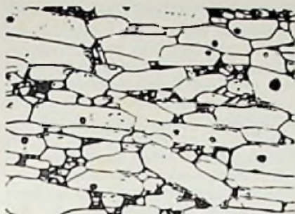
Bild 16. Horizontale magnetische Vorzugsrichtung der Einbereichsteilchen beim Bariumferrit
