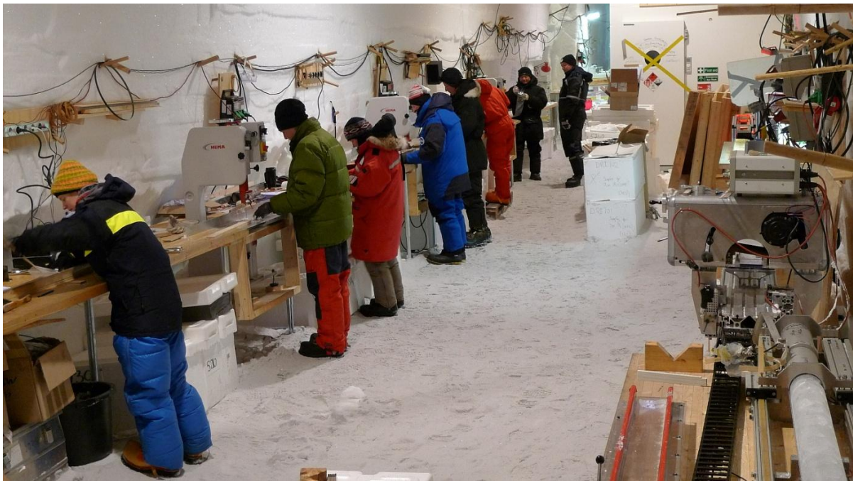
Abb. 14 Untertage-Werkbank (science trench). Arbeitsteilung zur NEEM-Eiskernbearbeitung. (Foto: Sepp Kipfstuhl; NEEM ice core drilling project, http://www.neem.ku.dk .)
