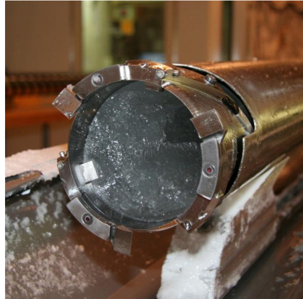
Abb. 4 Bohrkopf mit Eiskern. (Foto: Marie Kjaergaard, 2010; NEEM ice core drilling project, http://www.neem.ku.dk. )
