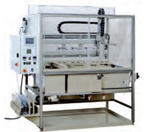
Anlage zum Elektropolieren von Edelstahl mit pneumatischem Handlingsystem und SPS-Steuerung
