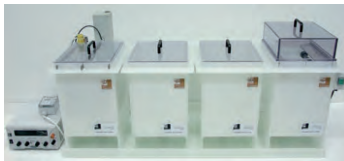
Modulare Tischgalvanisierwannen zum Elektropolieren von Kleinteilen
