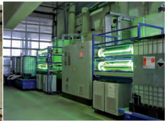
Die 2008 in Betrieb genommene Trommelanlage von Asmega (links) sowie Abwasserbehandlung durch UV-Bestrahlung von a.c.k./Karlsruhe
