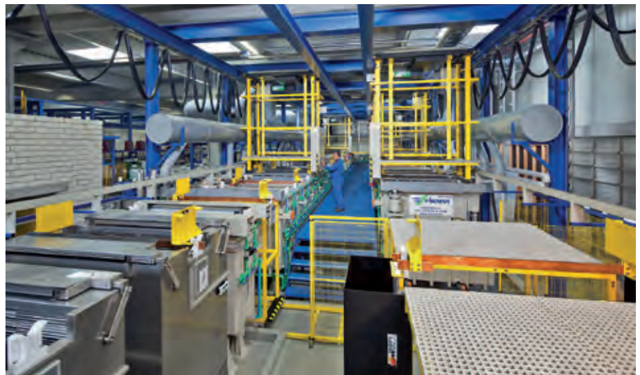
Die vor kurzem neu in Betrieb gegangene Gestellanlage für die Beschichtung mit Zink-Nickel und verschiedenen Nachbehandlungen
