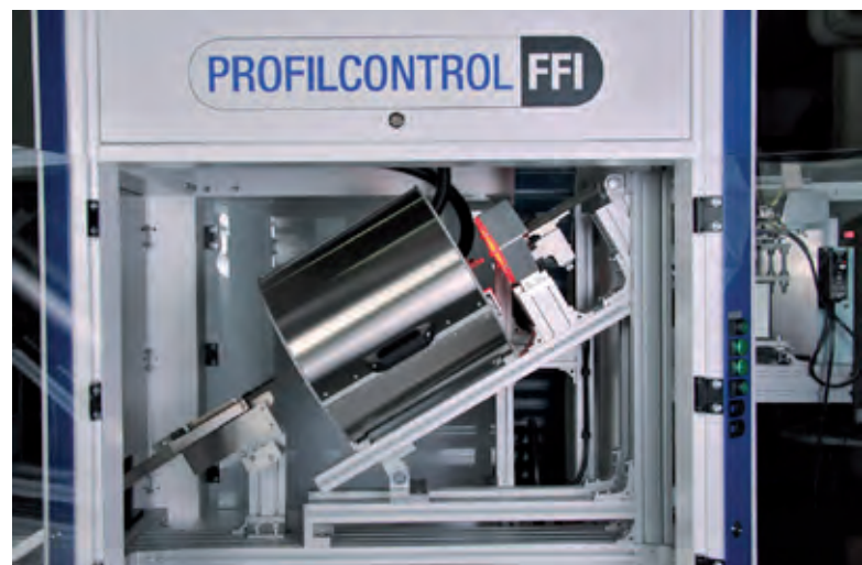
Die Rohrabschnitte werden von rechts oben automatisch zugeführt und gelangen über eine Rutsche in den Messkopf, danach in die Gut-Schlecht-Sortierung
