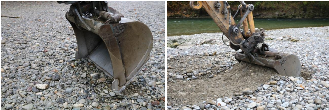
Abbildung 3.7: (links) typische Entnahme einer Deckschicht, (rechts) typische Entnahme der Unterschicht
