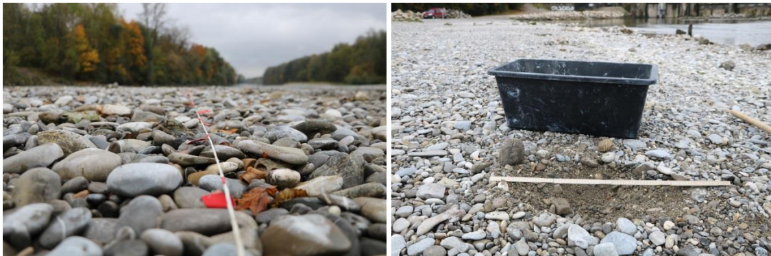
Abbildung 3.8: (links) Linienzahlanalyse, (rechts) händische Volumenprobenentnahme
