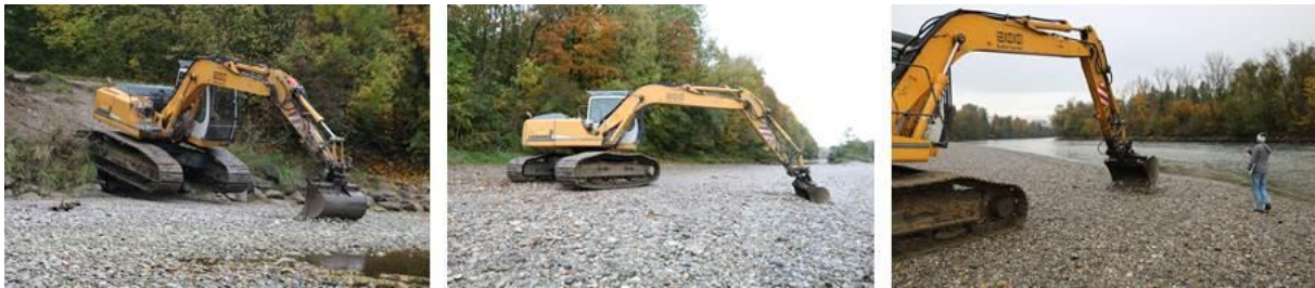
Abbildung 3.5: Volumenprobeentnahme mittels Baggerschurf
