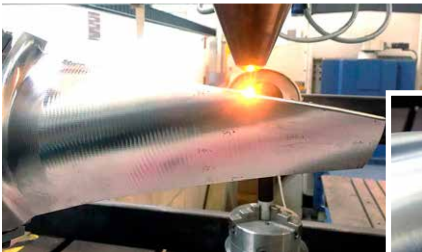
Reparatur einer Turbinenschaufel durch Laserauftragsschweißen. (Bilder: Chiron)
