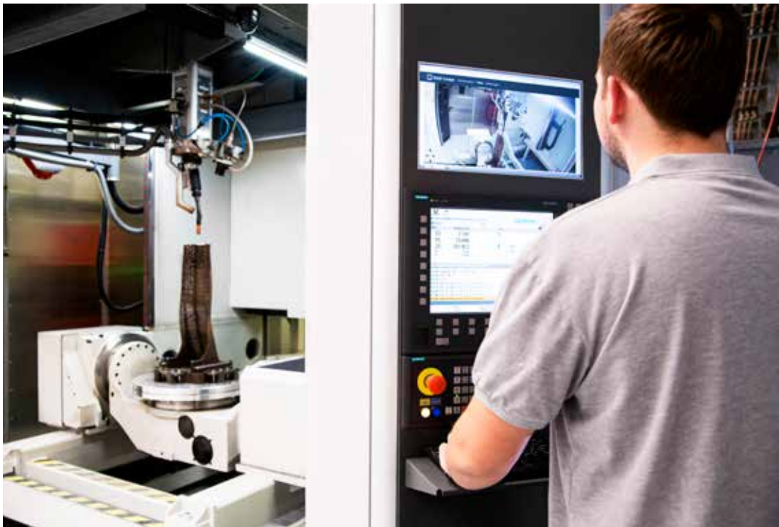
Die WAAM-Anlage nutzt Lichtbogenschiweißen zum schichtweisen Aufbau des Bauteils. Ein Metalldraht wird mithilfe eines Schweißbrenners an der richtigen Stelle verschmolzen und formt so das gewünschte Rohteil. (Bild: FIT AG/Lisa Kirk)
