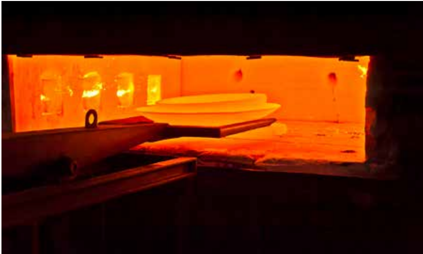
Ohne Umspannen oder Abtrennen von den Segmentpaletten direkt in die thermische Nachbehandlung.
