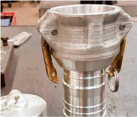
SP3D-gefertigter Schlauchanschluss im Auftrag der Royal Australian Navy. (Bild: SPEE3D & RAN)
