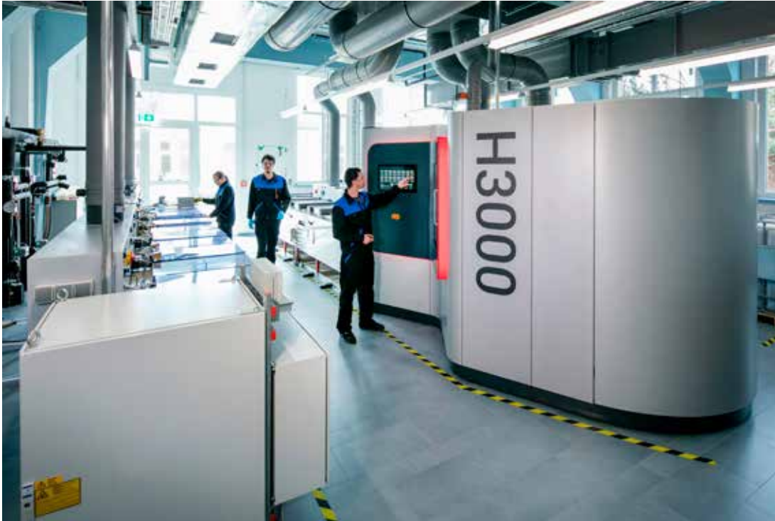
Das H3000 Finishing-Modul ist der Einstieg in das vollautomatisierte Post-Processing Hirtisieren® nach dem 3D-Druck.
