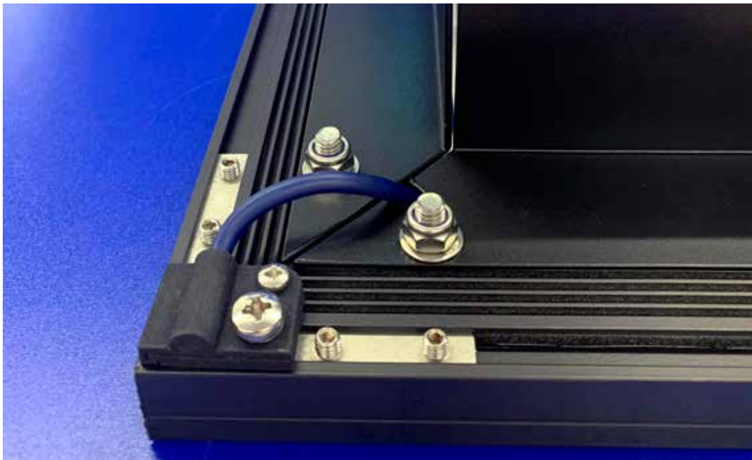
Die zweiteilige ineinandergreifende Kabelklemme von Spanlite verringert die Zuglast auf das Kabel und bietet gleichzeitig Schutz vor den Kanten des Aluminiumgehäuses.
