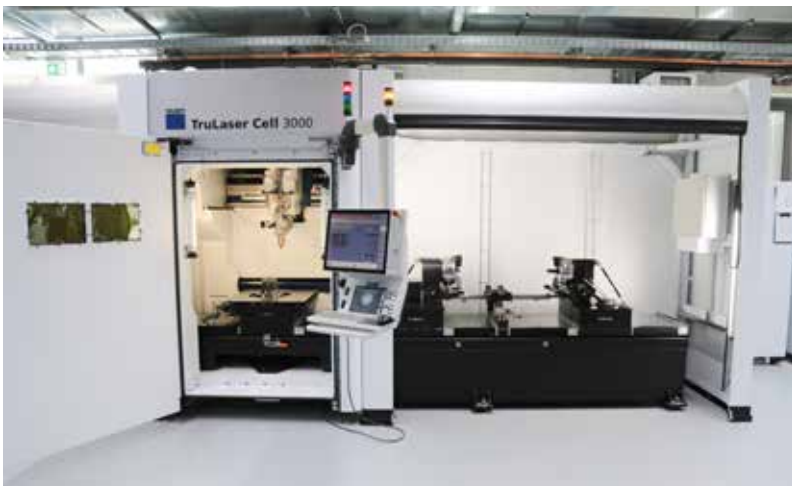
Die TruLaser Cell 3000 bei Toolcraft verfügt über eine zusätzliche A-Achse für die Erstellung und Beschichtung von Rotationskörpern.
