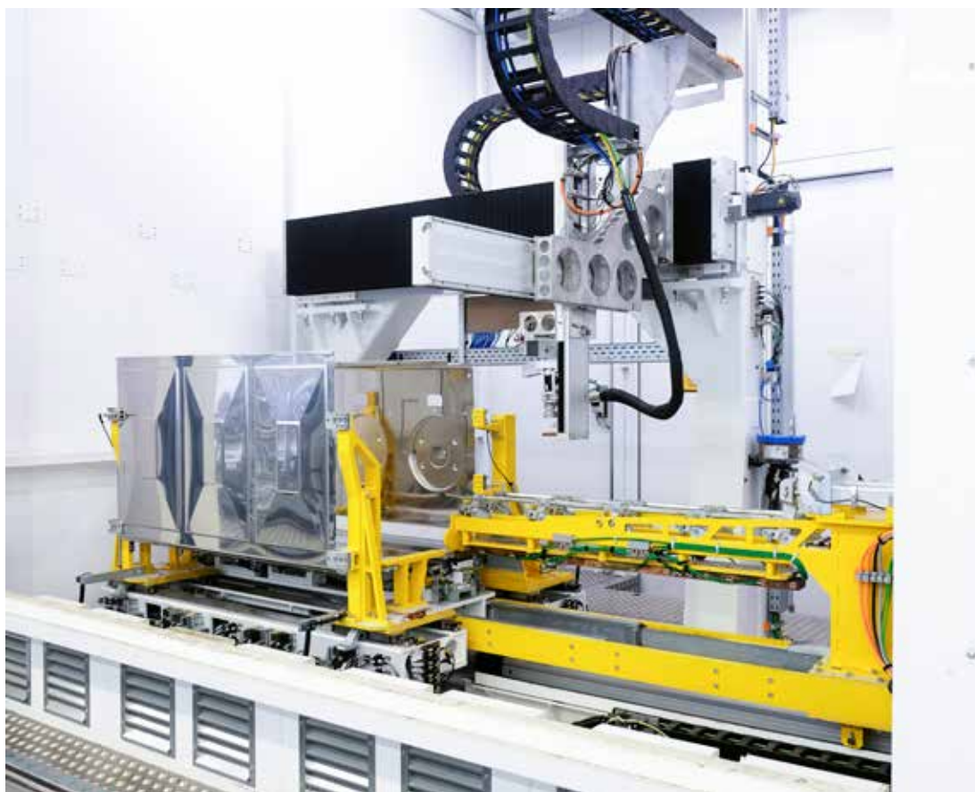
Präzise Ergebnisse bei der Serienfertigung: Füge- und Schweißprozesse innerhalb einer von vier Schweißzellen.
