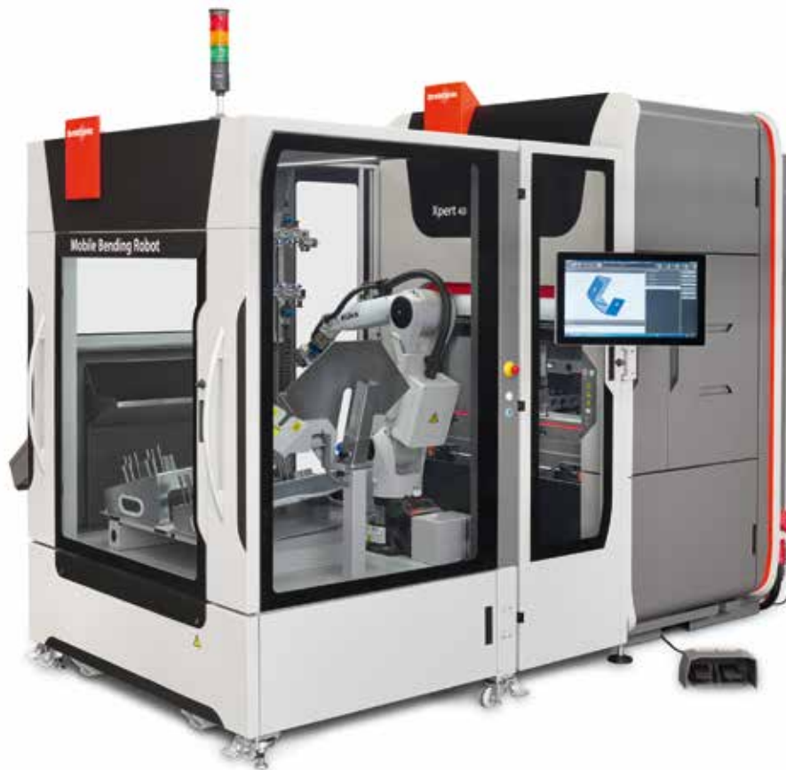
Biegeautomation auf engstem Raum: Biegeperformance der Abkantpresse Xpert 40 oder 80 kombiniert mit der Produktivität des Mobile Bending Robot.
