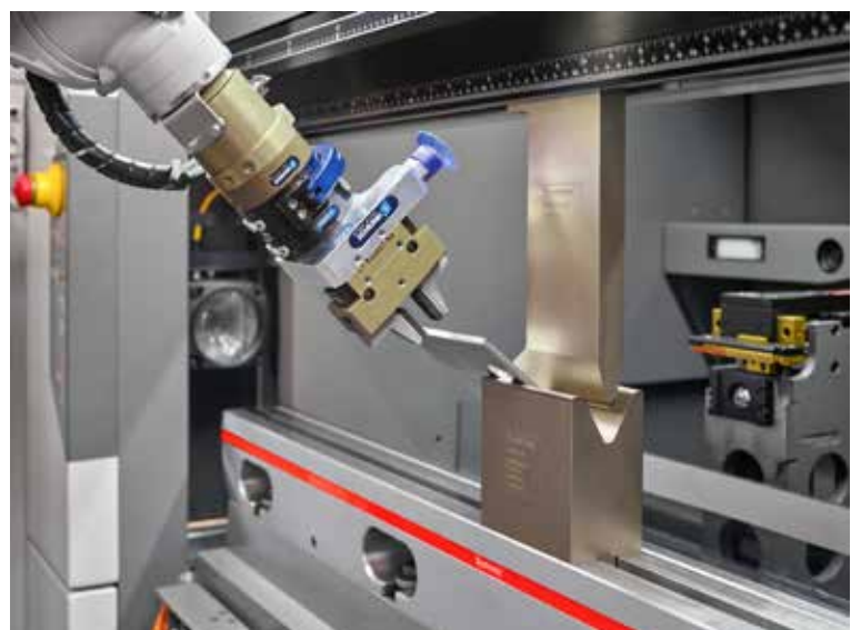
In der Mobile Bending Cell arbeitet ein sechsachsiger Roboter, der die Biegeteile in jeder beliebigen Position exakt an die Abkantpresse führt.
