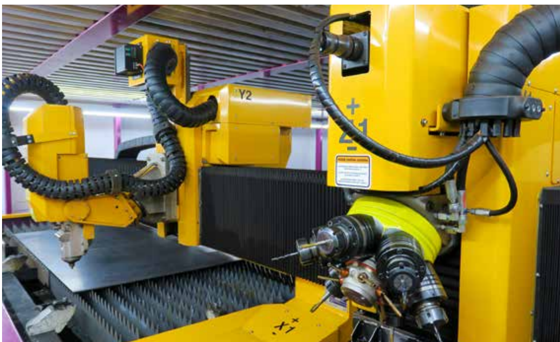
Mit der MSF-Laserschneidanlage können einfache V- und X-Nähte sowie auch komplexe Y- oder K-Nähte mit Stegverlauf an das Flachmaterial angebracht werden. Zusätzlich besteht die Möglichkeit zum Fasenschneiden, Bohren und Gewindeschneiden.
