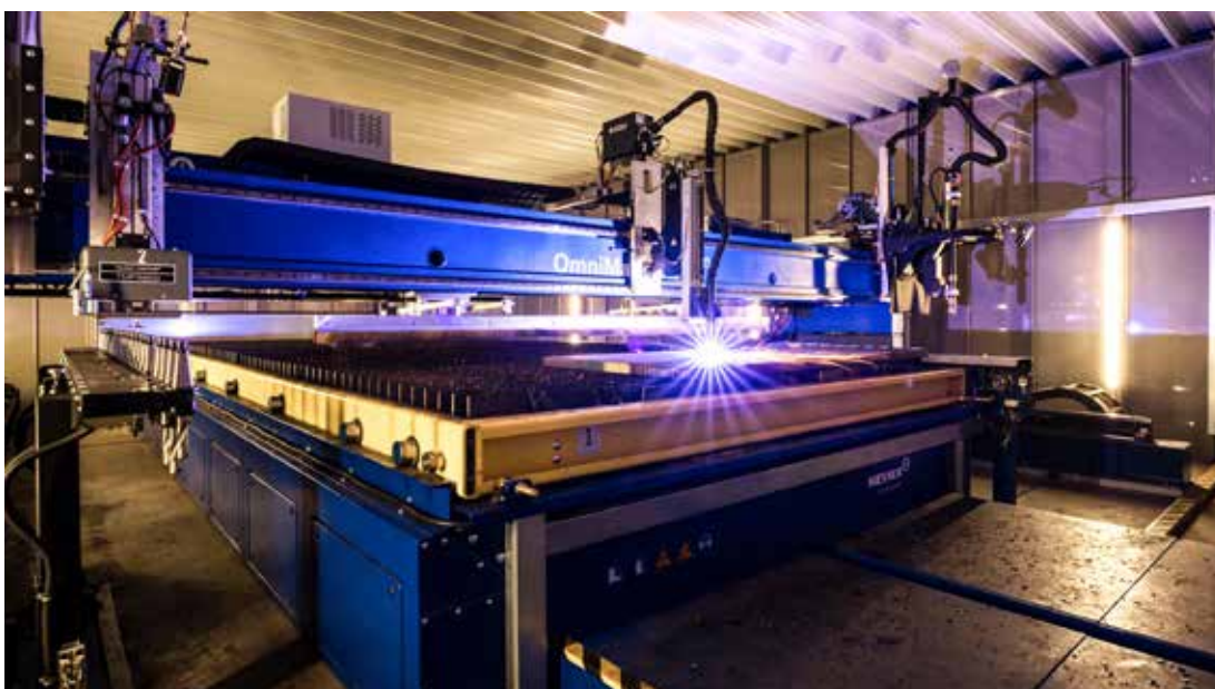
Die OmniMat® Schneidmaschine ist mit dem Skew Delta Plasma-Fasenaggregat zur Schweißnahtvorbereitung ausgestattet.
