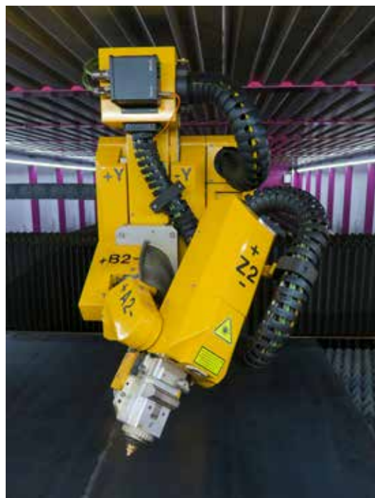
Integriert wurde unter anderem ein Laserrotator zum Fasenschneiden, beispielsweise zur Schweißnahtvorbereitung bis 45° .
