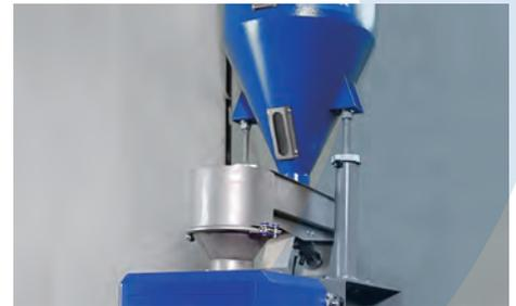
Das Material wird über eine Dosierrinne aufgegeben, die sowohl über die Stromaufnahme des Antriebsmotors als auch über das Temperaturkontrollsystem gesteuert wird.
