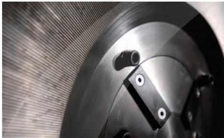
Zerma-Prallscheibenmühlen können entweder mit einteiligen Scheiben oder mit Mahlsegmenten bestückt werden. Scheiben wie auch Segmente sind aus hochwertigem Werkzeugstahl gefertigt und können zusätzlich mit einer verschleißarmen Beschichtung behandelt werden.
