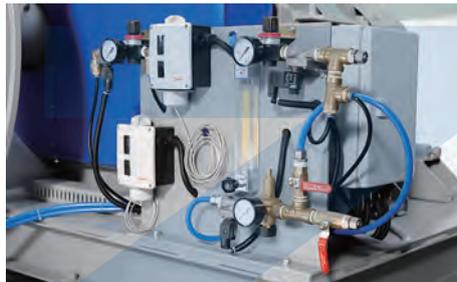
Ein automatisches Kühlsystem kontrolliert während des Mahlvorganges permanent die Temperatur des Materials.
