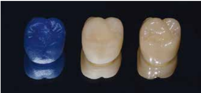
Abb. 6: Krone: gedruckt aus Castable Resin (links), gepresst (Mitte) und mit Glanzbrand (rechts).
