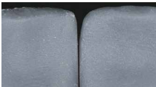
Abb. 2: Inzisalkanten eines DLP-gedruckten Modells in einer Schichtdicke von 100 µm und 25 µm.
