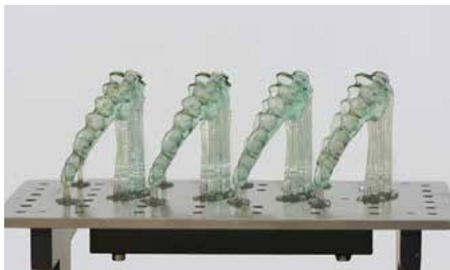
Abb. 4: Vertikal gedruckte Aufbisschienen mit Stützstrukturen auf der Bauplatte.
