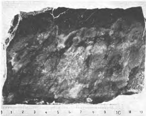
Abb. 9. Aufnahme eines polierten Anschliffes einer diffus-wolkigen Absonderung von chlorithaltigem Eisenjaspit bis Roteisenstein. Dunkle Partien sind Aggregate von Chlorit, Karbonat und Quarz, die heller reflektierenden Flächen enthalten Anreicherungen von kryptokristallinem bis feinschuppigem Hämatit. Die Textur könnte entweder durch Turbulenzen infolge austretender Gase und Lösungen oder dann durch subaquatische Gleitungen (Wellenschlag, Setzungserscheinungen?) im diagenetisch noch wenig verfestigten chemischen Sediment entstanden sein. Aufnahme Zuber, Geol. Institut ETH Zürich.
