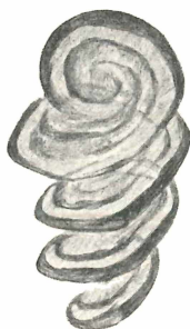
Abb. 7 Zerdrücktes Korn wendeltreppenartig aufgewunden.
