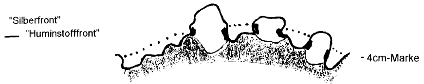
Abb. 2a: Die schnelllaufenden Lösungsanteile der "Huminstofffront" durchbrechen die "Silberfront" bei der 4cm-Marke.
