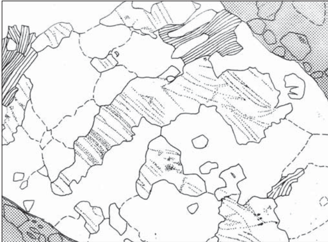
Abb. 7: Verheilte Mikrorisse in Quarz eines Migmatit-Bruchstückes; Kataklasit vom Stäpfeleisen (TK Freiburg SO). Weiße Flächen: Feldspäte, feines Punktraster: Kataklasit, schraffiert: Biotit. Bildbreite 3 mm.
