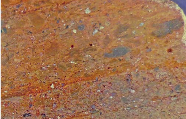
Abb. 4: Kataklasit, Anschliff Thomashof im Rechtenbachtal (TK Freiburg SO). Stark zerkleinertes Gestein mit vielen, frisch erhaltenen Feldspat- und Quarzklasten (weiß) und umgewandelten, bis über ein Zentimeter großen Kataklasitklasten älterer Generationen (grau und bräunlich in verschiedenen Farbtönen). Bildbreite 4,5 cm.
