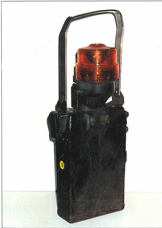
Abb. 7: FRIWO-Zugschlussblinkleuchte vom Typ 14202-074 S. Höhe (ohne Tragegriff): 287 mm Breite: 113 mm Tiefe: 46 mm
