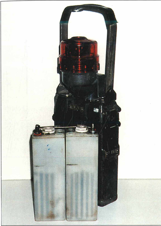
Abb. 6: FRIWO-Zugschlussleuchte vom Typ 14202-070 S Höhe (ohne Tragegriff): 287 mm Breite: 113 mm Tiefe: 46 mm Bemerk.: Sonderleuchte mit roter Rundlichtkappe und zweizelligen NiCd-Akkumulator vom Typ FN 14 K.
