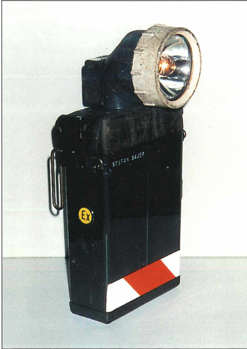
Abb. 8: FRIWO-Handleuchte vom Typ 14202-060 Ex. Höhe (ohne Tragegriff): 254 mm Breite: 113 mm Tiefe: 46 mm Tiefe des Leuchtenkopfes: 94 mm; Bemerk.: Sonderleuchte ohne Tragegriff und Knopföse, dafür aber mit Lampenhalter.
