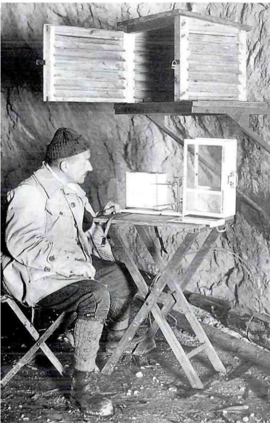
Abb. 1: Wetterhütte in der Dachstein-Rieseneishöhle, darunter Thermohygrograph auf transportablem Klapp-Manipulationstisch, seitlich daneben sitzend Leo HANDL. - Bildarchiv der KHA-NHM, KYRLE-Bild-evidenzen Bild Nr. D-025: G. KYRLE 1929.
