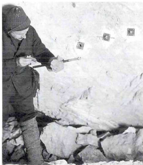
Abb. 3: Meßstelle zur Ermittlung der Gesteinstemperaturen in Bohrlöchern mit 50 cm, 100 cm und 150 cm Tiefe. – Bildarchiv der KHA-NHM, KYRLE-Bildevidenzen Bild Nr. Bild D-203; G. KYRLE 1929.
