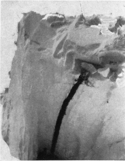
Abb. 3. Ein sogenanntes „Kriechschnee-profil“ freigelegt. Im Laufe eines Monats hat sich der ursprünglich gerade Sägemehlstrang unter dem Einfluß des Schneekriechens gekrümmt. Die Abweichung von der Lotrechten ist unmittelbar über dem Erdboden gering, an der Schneeoberfläche am größten und beträgt hier 30 cm
