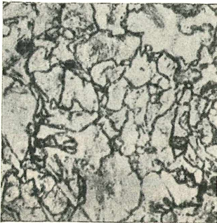
Abb. 7. Stahl „H“ (0,40% C, 0,90% Mn, 0,90% Si). Geätzt mit Xylol-Pikrinsäure. Abbildungsmaßstab 550:1.
