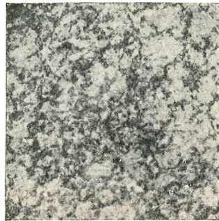
Abb. 7. Stahl „H“ (0,40% C, 0,90% Mn, 0,90% Si). Geätzt mit Xylol-Pikrinsäure. Abbildungsmaßstab 550:1.
